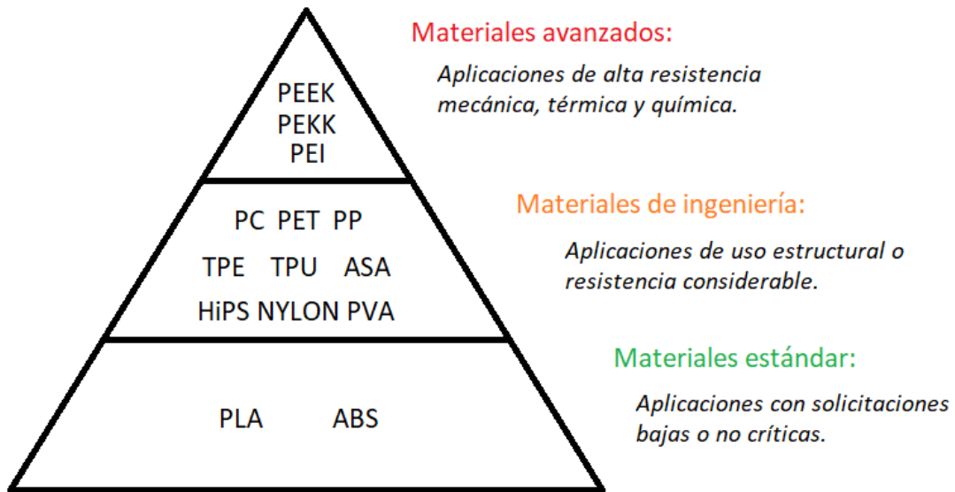
Imagen 15: Esquema de materiales utilizados en impresión 3D (Créditos: elaboración propia)
