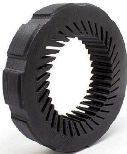
Imagen 76: Pieza fabricada en Nylon con fibra de carbono (Créditos: fillamentum)
