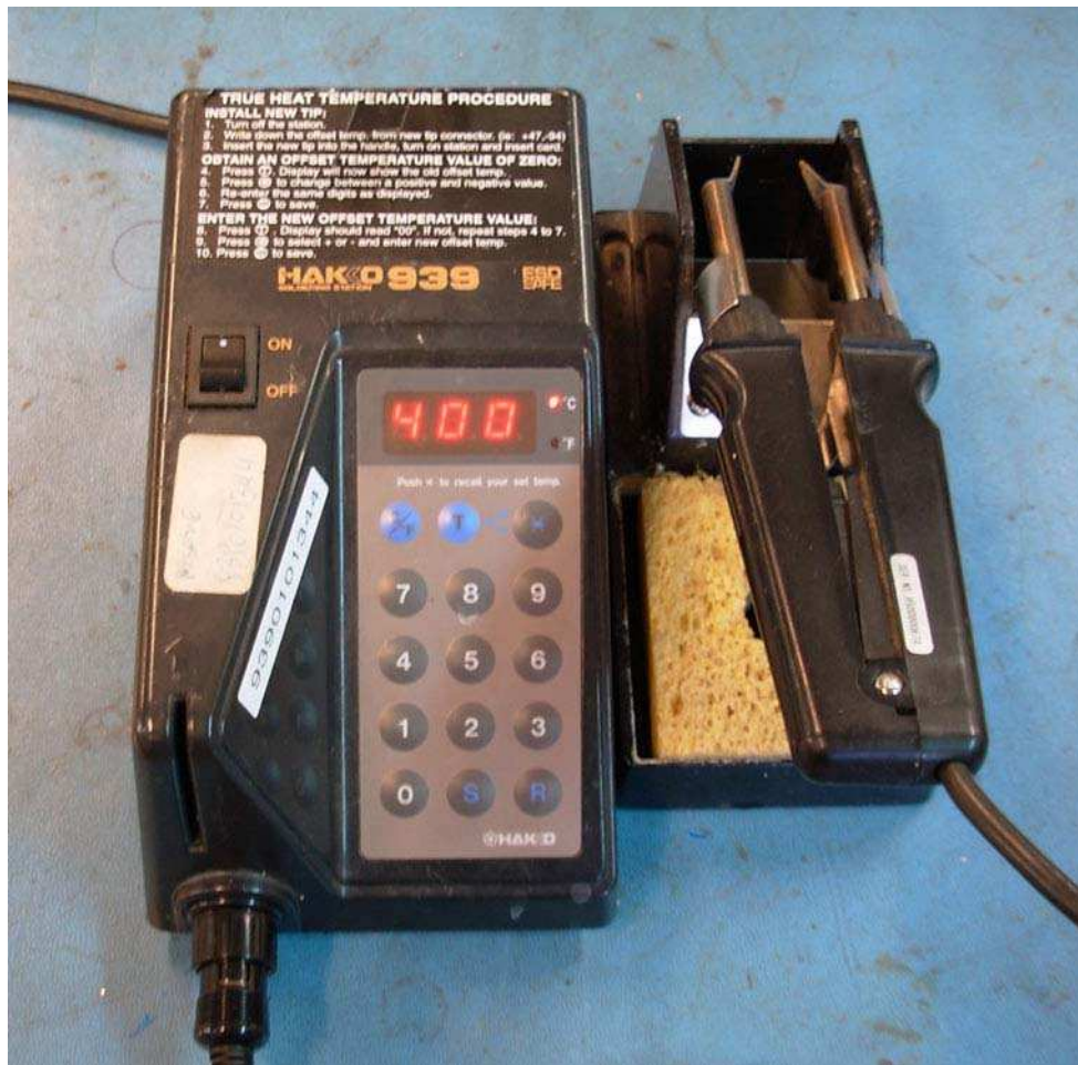
Figura 5.7: Estación de soldado.
