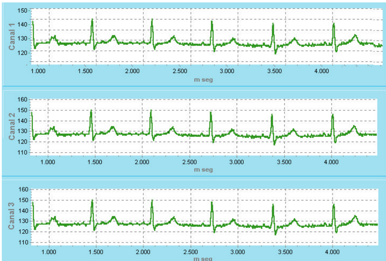
FIGURA 9.4: REGISTRO ECG MEDIDO CON LOS TRES CANALES CONECTADOS A UN MISMO PAR DE ELECTRODOS
