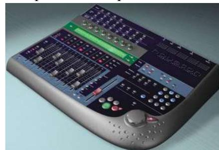
*Ventajas:* posee faders motorizados y una gran capacidad de control sobre el software “Cubase” y otros de la misma empresa.
