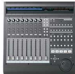
Como características principales, este controlador posee 9 faders motorizados de 100mm, uno de los cuales se utiliza como master. Además posee un encoder rotativo por cada canal, al cual se pueden asignar distintas funciones y un único display LCD de dos líneas.
