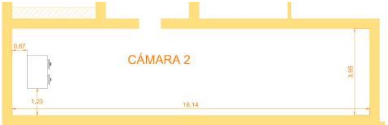
Figura 20 - Ubicación del equipo de enfriamiento para la cámara 2.
