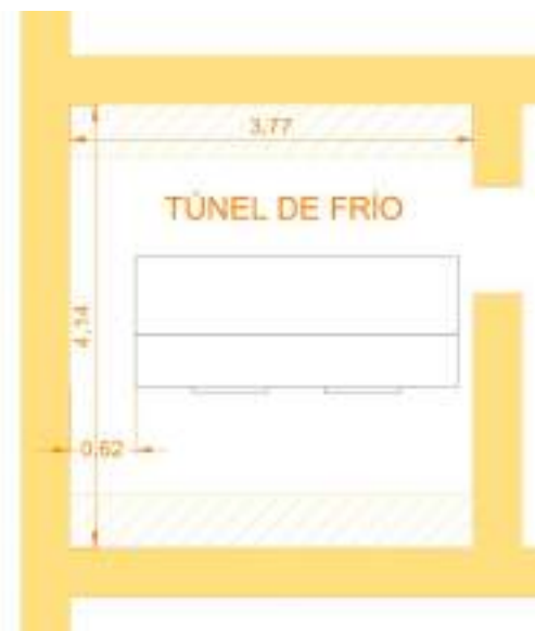
Figura 14 - Ubicación del equipo de enfriamiento para el túnel
