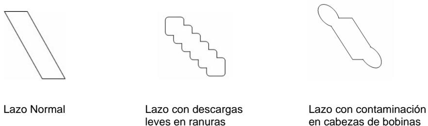
Figura 85. Formas típicas de los lazos visualizados en osciloscopio
