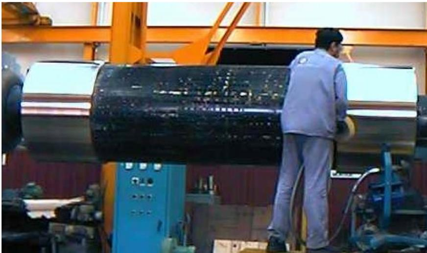
Figura 93. Rotor con calotas nuevas
