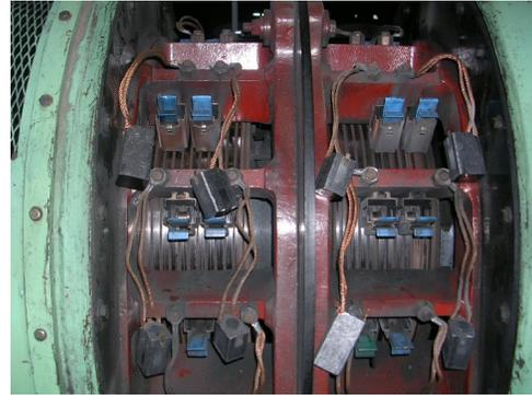
Figura 20. Dispositivo porta escobillas
