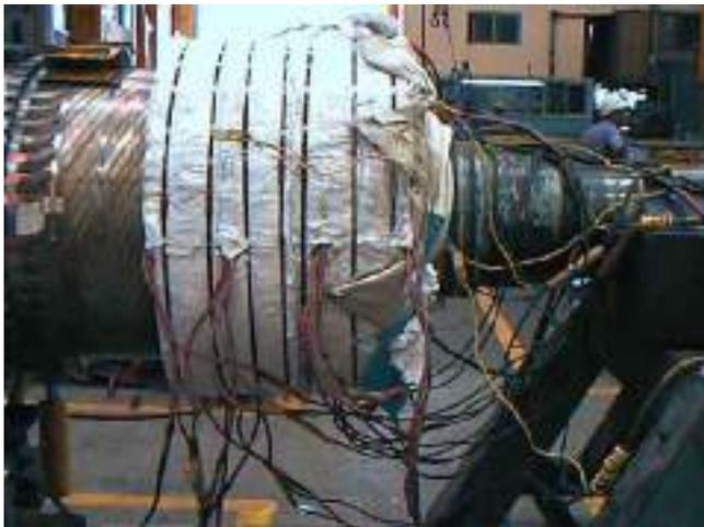
Figura 91. Calentamiento con manta térmica
