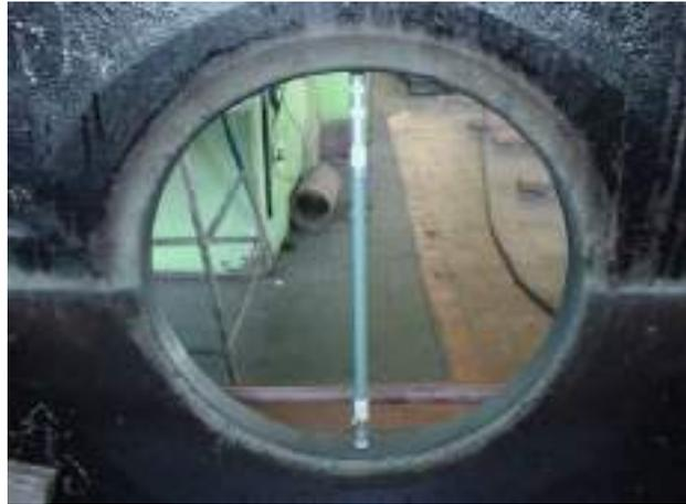
Figura 61. Posición del micrómetro
