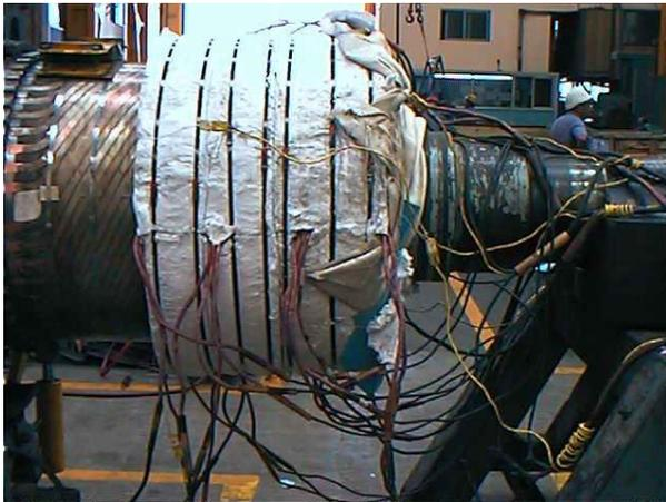
Figura 91. Calentamiento con manta térmica
