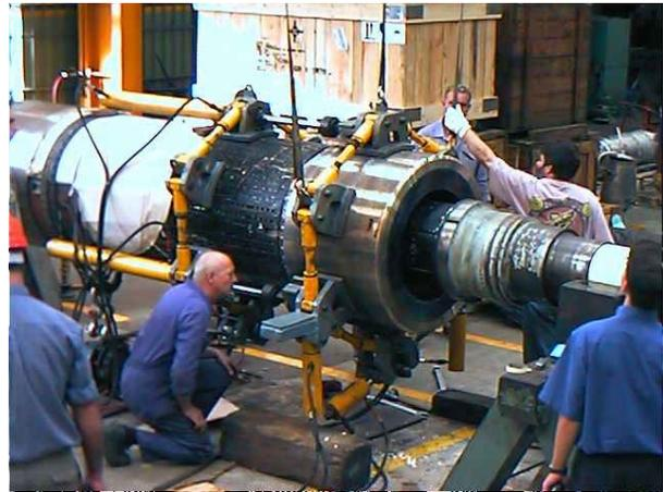
Figura 92. Sistema hidráulico de extracción
