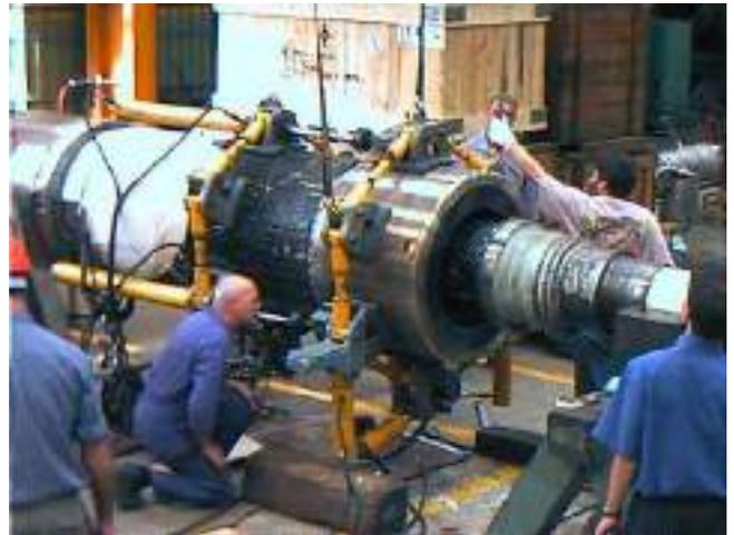
Figura 92. Sistema hidráulico de extracción
