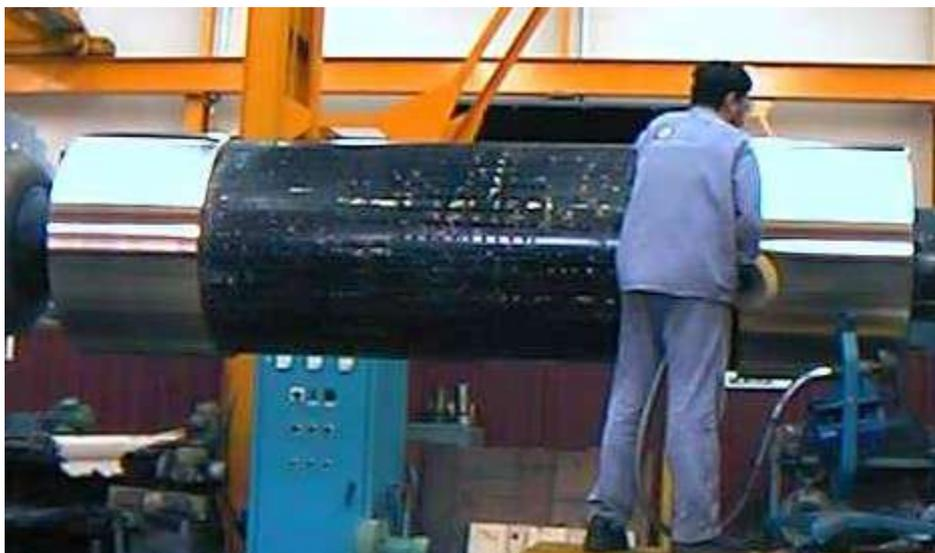
Figura 93. Rotor con calotas nuevas
