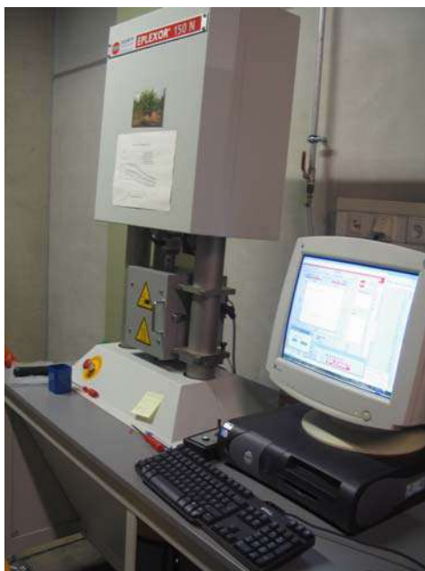
Figura 5. Analizador dinámico mecánico (DMA) Gabo Eplexor 150 N.
