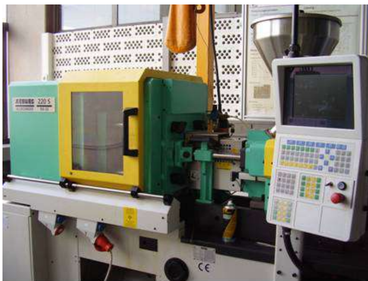
Figura 32. Máquina de moldeo por inyección Arburg 220 S Allrounder 150-30 utilizada para la fabricación de micro probetas de tracción a partir de policarbonato virgen y materiales concentrados obtenidos en la etapa II del trabajo.
