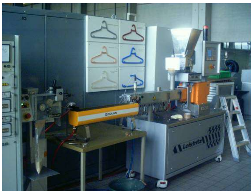
Figura 18. Extrusora de doble tornillo corrotantes Leistritz ZSP 18HP y máquina pelletizadora Collin CSG 171/2 utilizadas para la preparación a través de mezcla en fundido.
