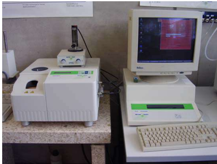
Figura 4. Analizador termogravimétrico Mettler – Toledo 851 e
