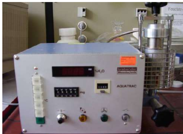
Figura 10. Equipo medidor de contenido de humedad Brabender AQUATRAC.
