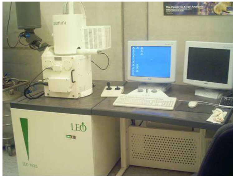
Figura 9. Microscopio electrónico de barrido LEO Gemini.
