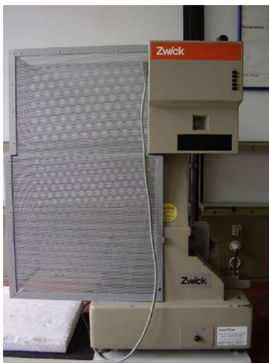
Figura 7. Máquina de impacto Zwick 5101.
