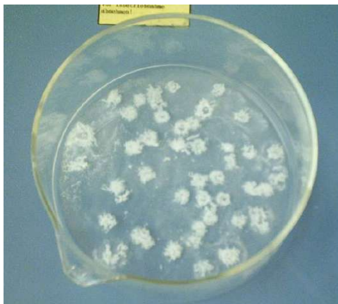
Figura 19. Copos de material precipitado en metanol al depositar gota a gota la solución mezcla de policarbonato-alúmina en tolueno, durante el proceso de obtención de muestras por el método de mezcla en solución y utilizando la secuencia experimental N°5.
