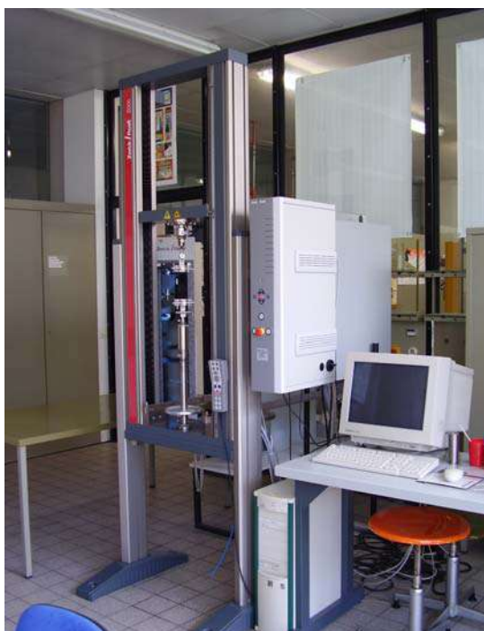
Figura 6. Máquina universal de ensayos Zwick/Roell Z005.
