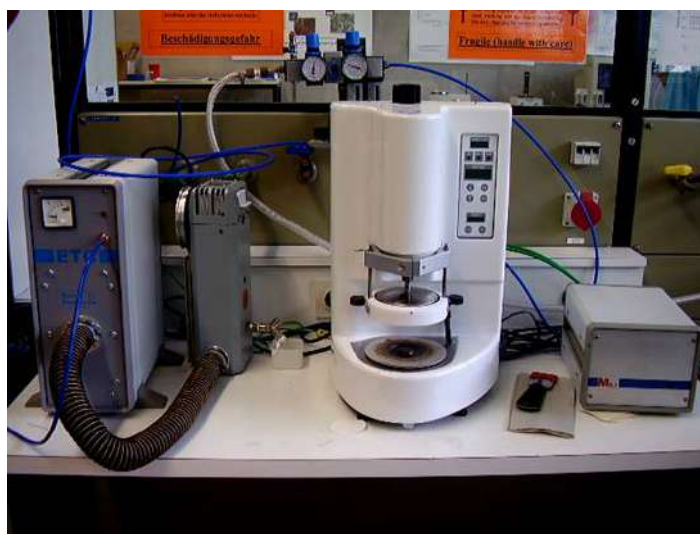
Figura 8. Reómetro de plato-plato Bohlin Instruments Gemini 200.
