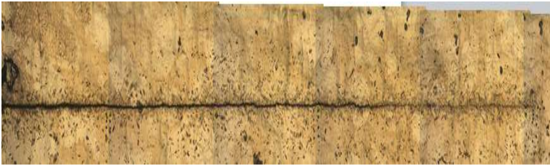
Figura E.2. Micrografía correspondiente a la propagación de una fisura en la región de Paris a una relación de carga de R = 0.3 .
