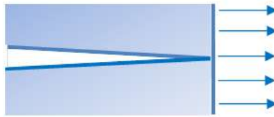
Figura 6.14. Representación de las tensiones generadas por la transformación martensítica sobre la parte delante de la zona transformada (contorno 4)
