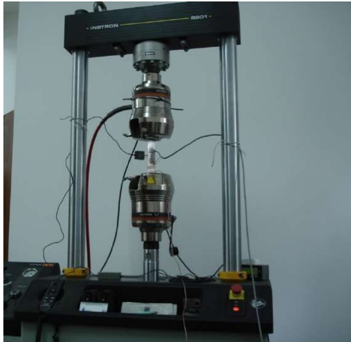
Figura 4.2. Máquina servo-hidráulica marca Instron de 10 kN de capacidad de carga.
