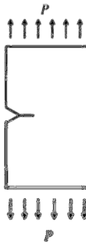
Figura 4.1. Probeta Tipo SENT (por sus siglas en inglés Single edge notch tension specimen). La probeta de esta figura muestra condiciones de carga uniforme sobre los bordes, a diferencia, de las probetas utilizadas en estos estudios en las que se la sometía condiciones de desplazamiento uniforme sobre los bordes.
