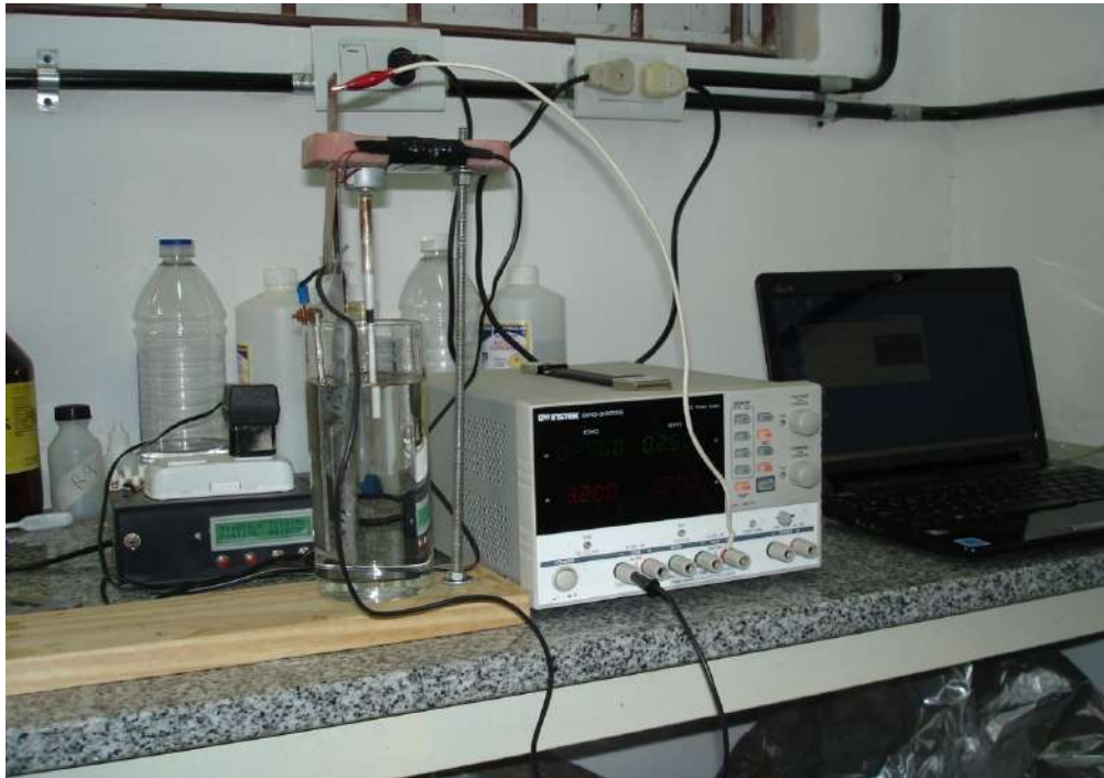
Figura F.3. Sistema implementado para electropulir. Incluye fuente, computadora para adquisición de datos, y sistema de regulación para el agitador.
