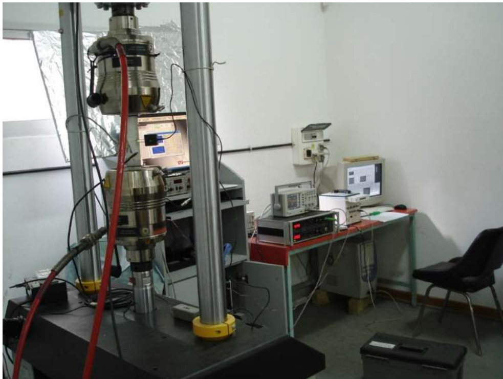
Figura E.4. Vista general de los equipos de adquisición, y control, junto con la maquina servo-hidráulica donde se realizaron la mayoría de los ensayos de propagación de fisuras por fatiga.
