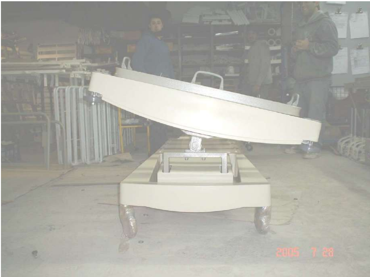
Cama lateral en el proceso de armado en fábrica, sin los cabezales colocados.
