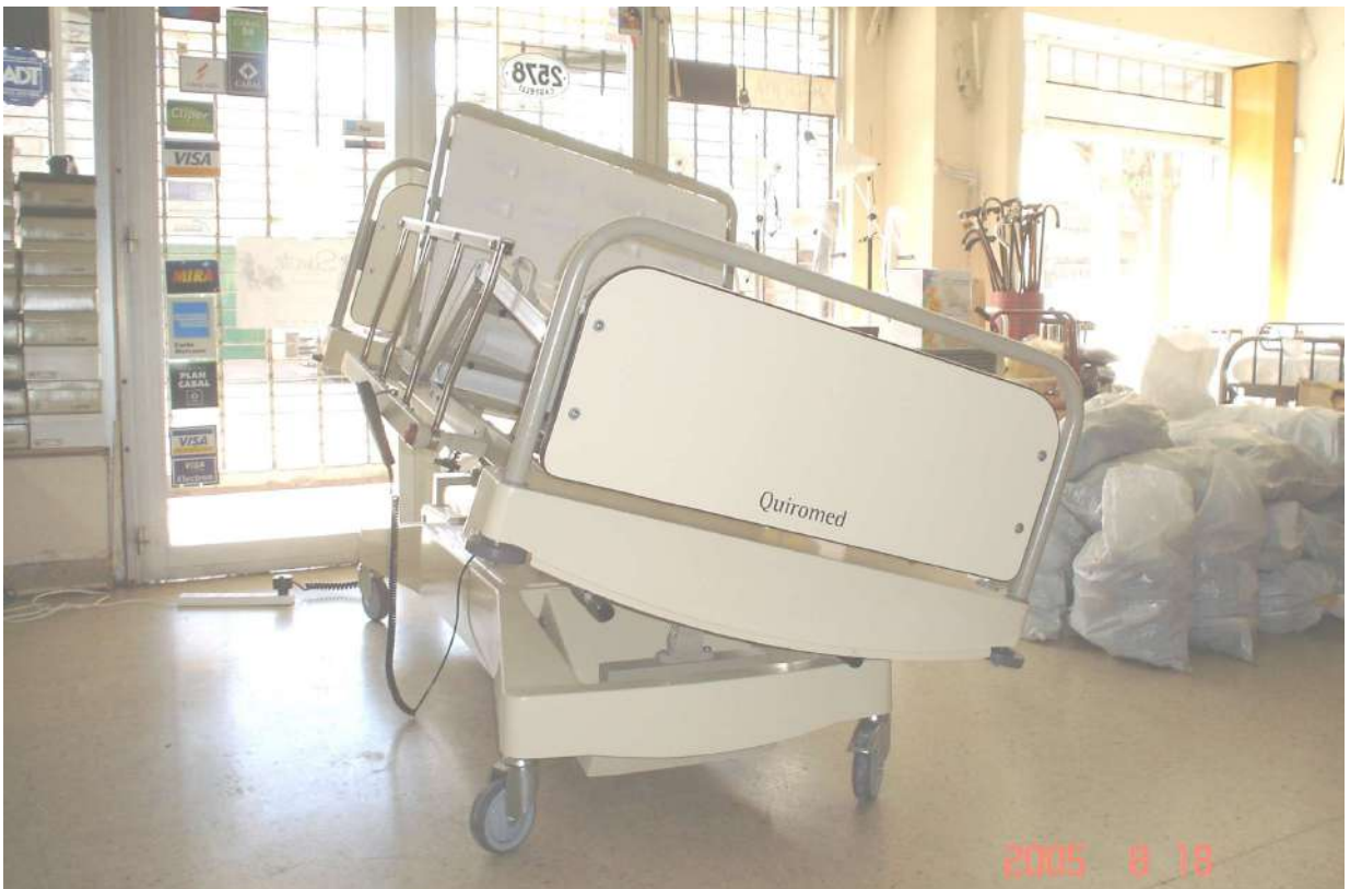
Cama lateral en movimiento accionando el mecanismo de lateralidad hacia la izquierda con una angulación final de 14^\circ sobre la horizontal.
