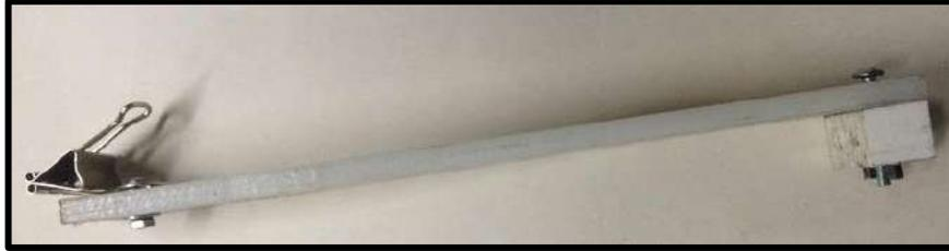
**Figura 3.30 - Instrumento para depósito por dipping terminado.**
