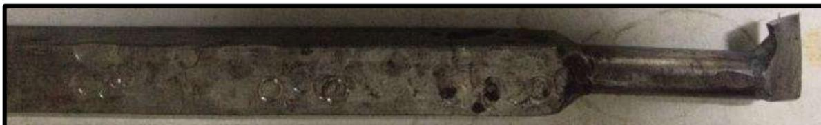
Figura 3.18 - Herramienta de interiores para torno paralelo.
