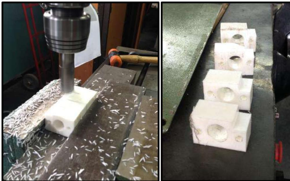
Figura 3.10 - Proceso de fresado y resultado en las piezas.
