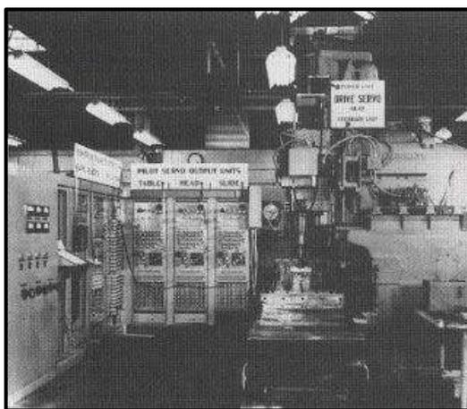
Figura 2.1 – Fresadora marca Cincinnati modificada en el MIT (1952).
