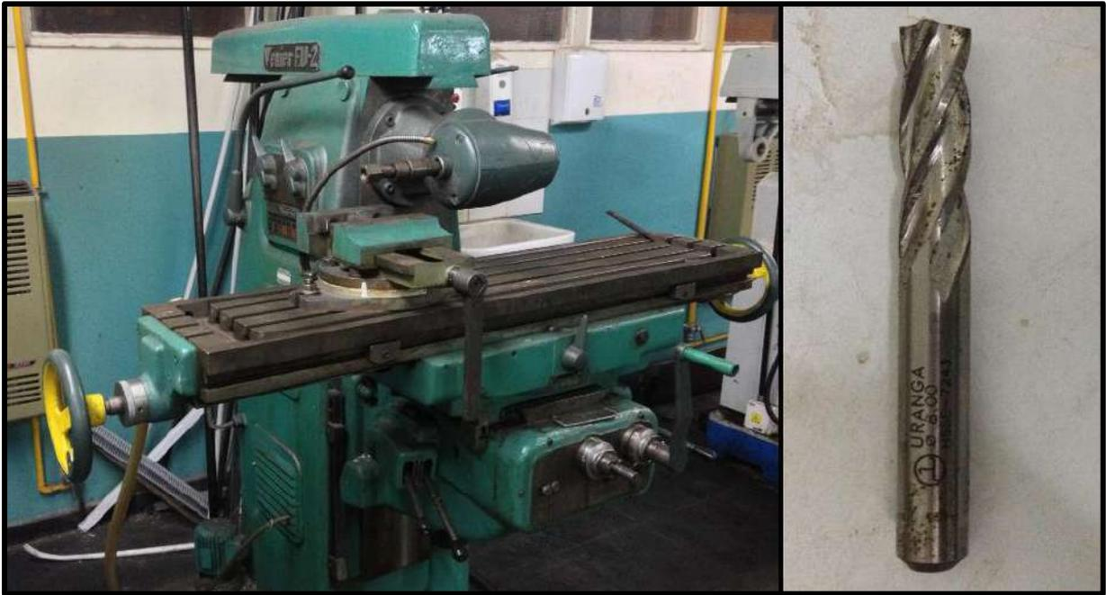
Figura 3.9 – Fresadora marca Venier y herramienta de corte utilizada.
