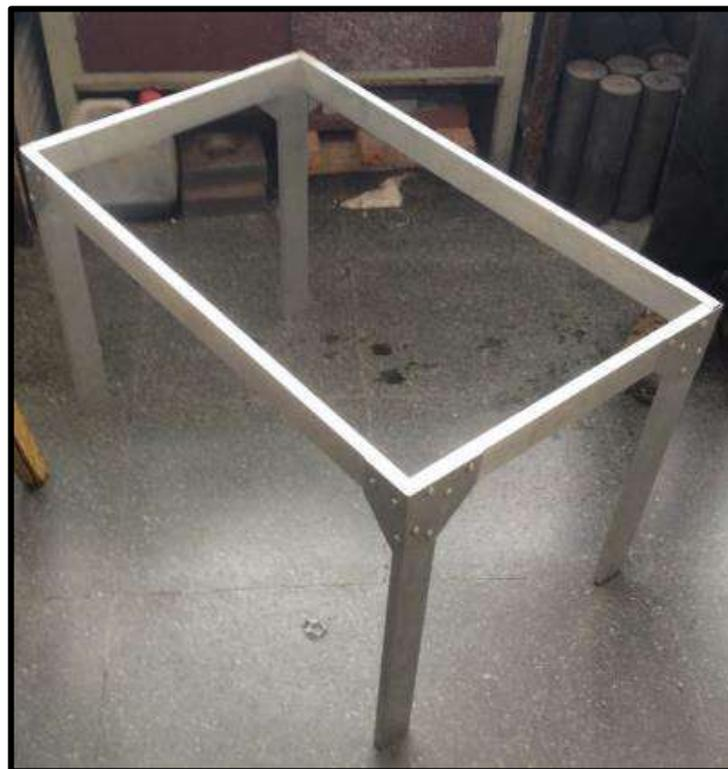
Figura 3.7 - Estructura principal ensamblada (sin los refuerzos).
