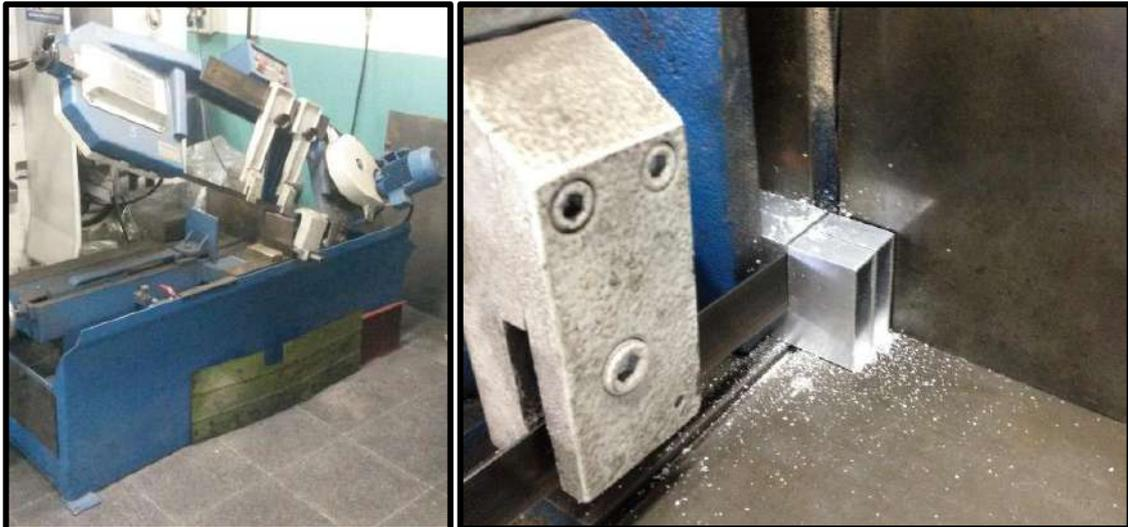
Figura 3.2 - Sierra de descenso hidráulico.
