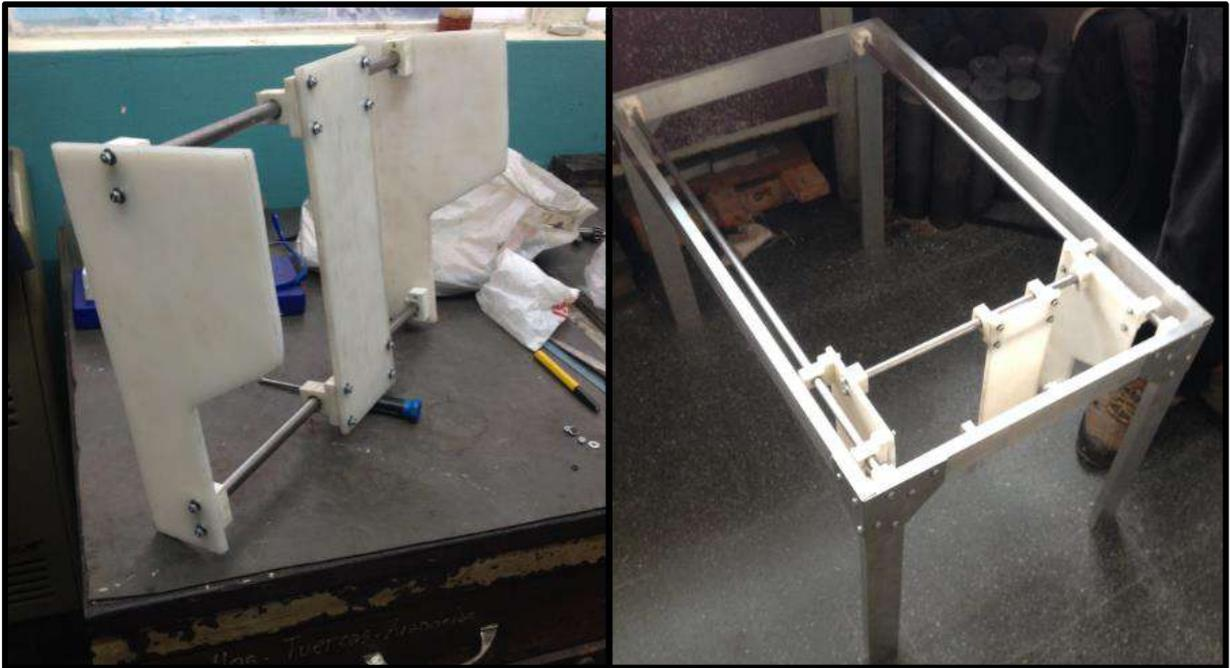
Figura 3.22 - Pre-ensamble de la torre en el puente móvil y en la estructura principal.
