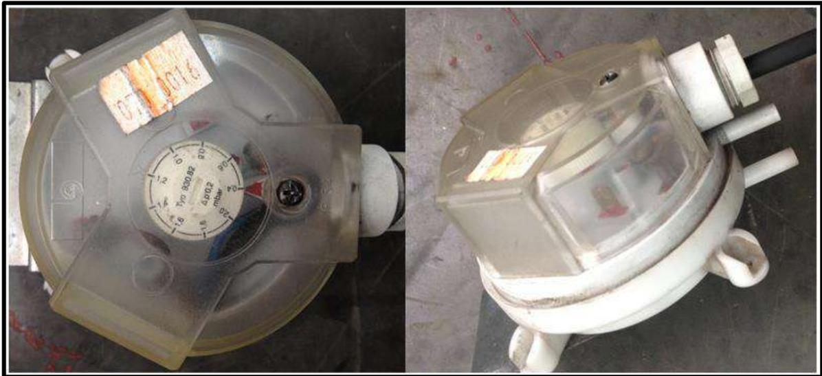
**Figura 4. 2 - Sensor diferencial de presión.**
