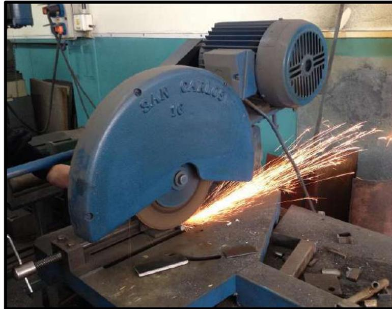
Figura 3.11 - Corte de varillas con sierra sensitiva.
