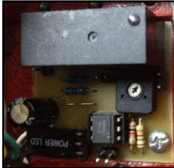
Figura 4. 34 - Placa para control de temperatura automático, montada sobre gabinete de placa calefactora
