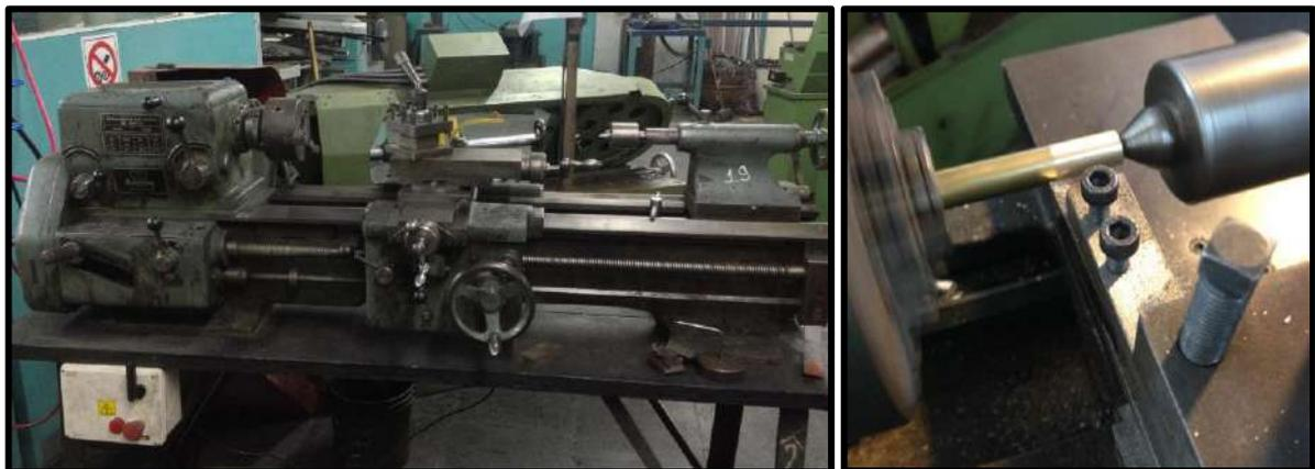
Figura 3.16 - Torno paralelo y proceso de mecanizado de rodillos.
