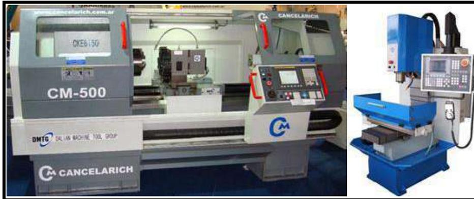
Figura 2.2 – Torno CNC Cancelarich (a la izquierda) y fresadora CNC de la misma marca (a la derecha).
