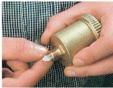
El funcionamiento de la válvula de descarga de aire automático es muy simple y se basa en el principio de flote de los cuerpos inmersos en un fluido. Cuando en el cuerpo de la válvula no existe acumulación de aire el flotador sube, cerrando el obturador. El descenso del flotador, causado por la acumulación de aire, produce la abertura del obturador y la consiguiente descarga de aire, que persiste hasta restablecer
