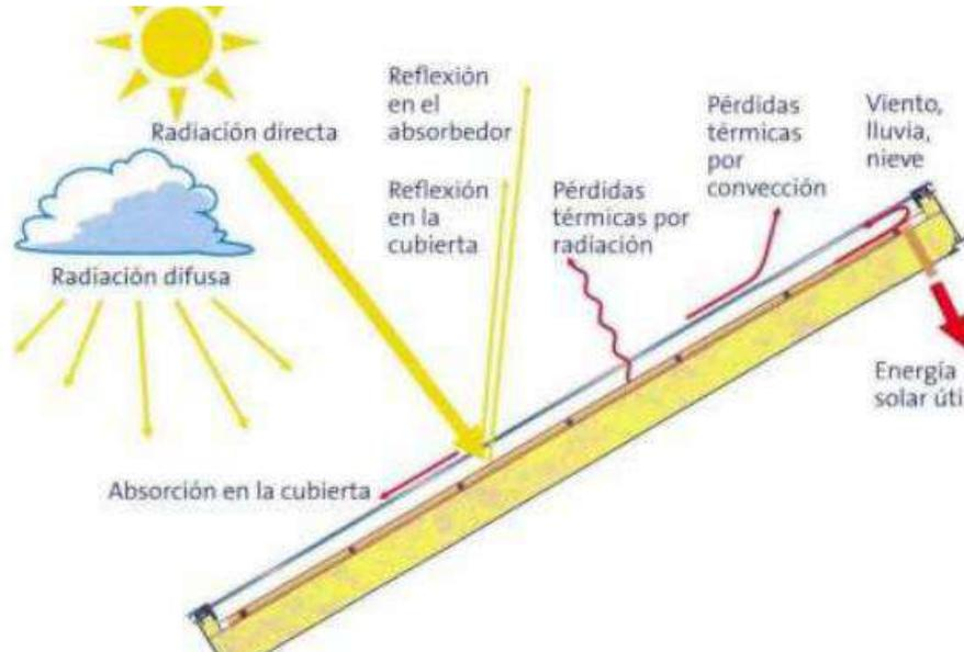
**Figura 4.3.1:** Intercambios energéticos de un captador solar plano.
