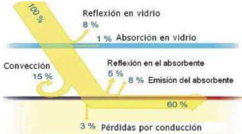
**Figura 4.3.2:** Pérdidas de un captador solar plano
