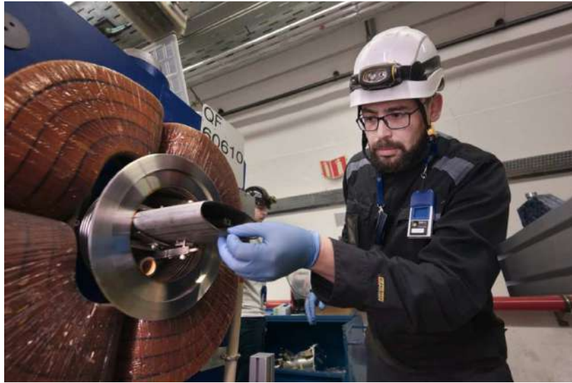
Figura 8 . Reacondicionamiento de la cavidad del acelerador SPS (super proton- synchrotron) del CERN en el centro de un electroimán de trayectoria
