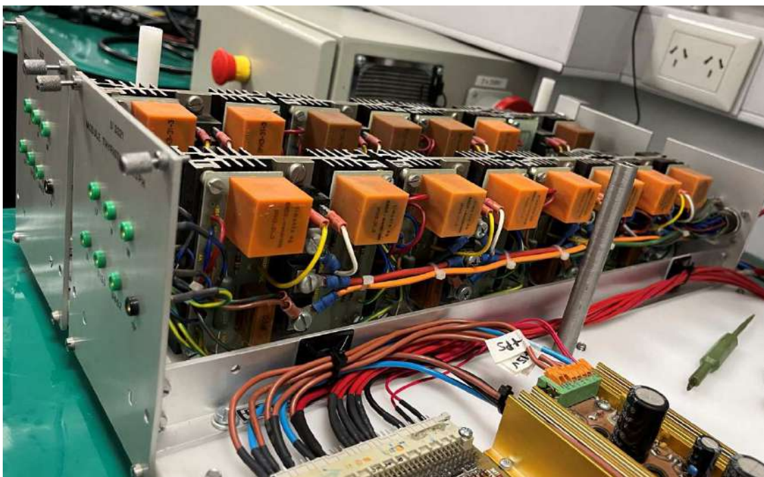
Figura 70. Vista lateral del stack de SCR.
