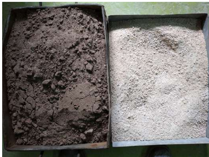
Figura 2. Agregados finos utilizados en el hormigón de rápida habilitación. Arena de Necochea (izquierda), Proconcrete (derecha)
