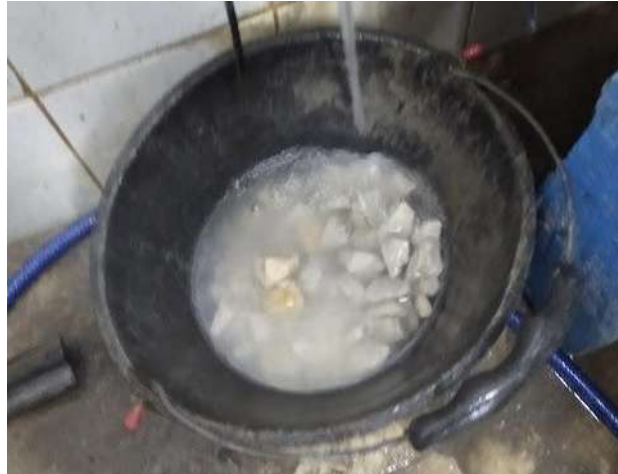
Figura 13. Lavado de Piedra 10-30
