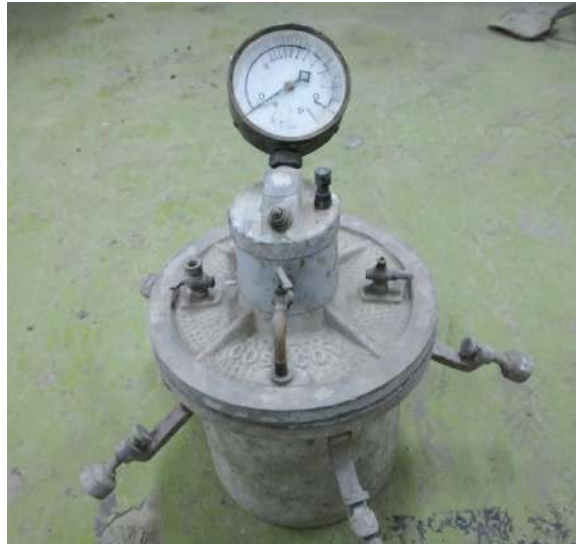
Figura 26. Olla de Washington tapada
