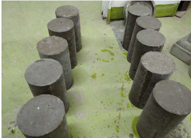
Figura 32. Probetas de hormigón de rápida habilitación endurecidas
