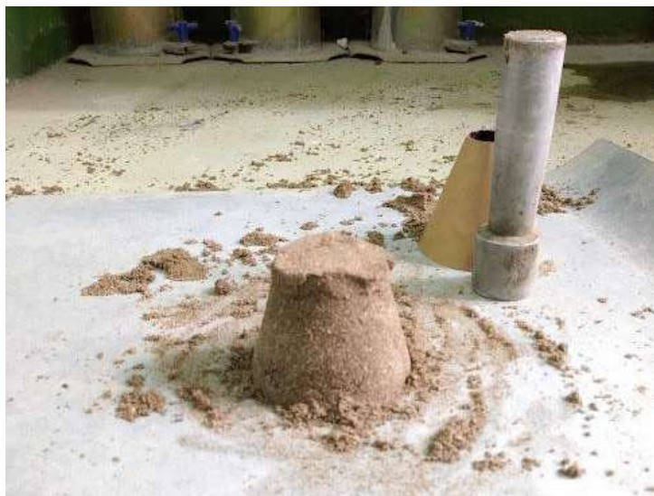
Figura 7. Arena con exceso de humedad
