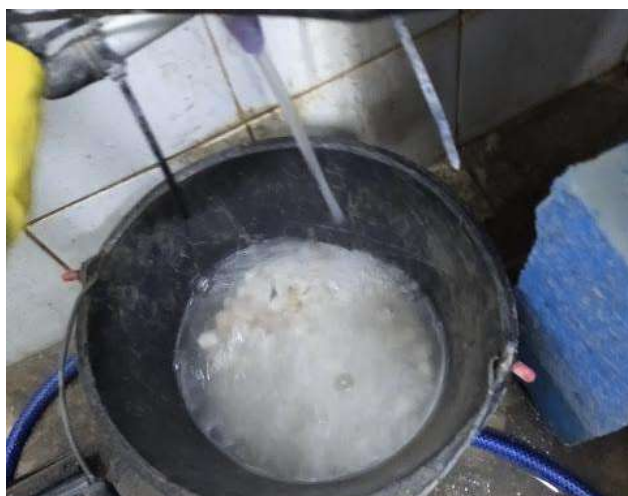
Figura 12. Lavado de Piedra 6-20
