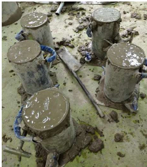
Figura 30. Moldes compactados y enrasados
