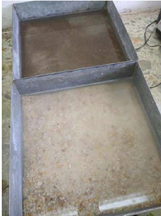
Figura 5. Arena y Proconcrete sumergidas en agua
