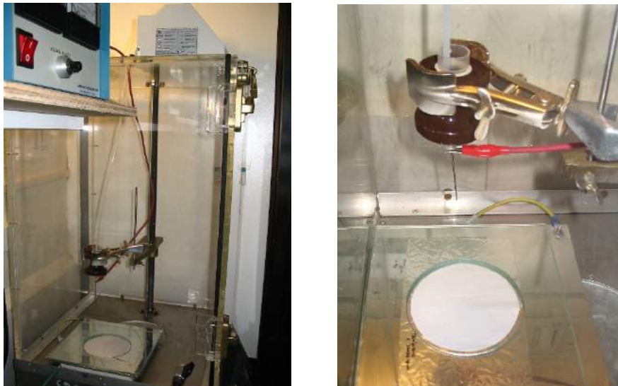
Fig. 1.5. Imagen del equipo de electrohilado empleado para procesos electrohidrodinámicos
