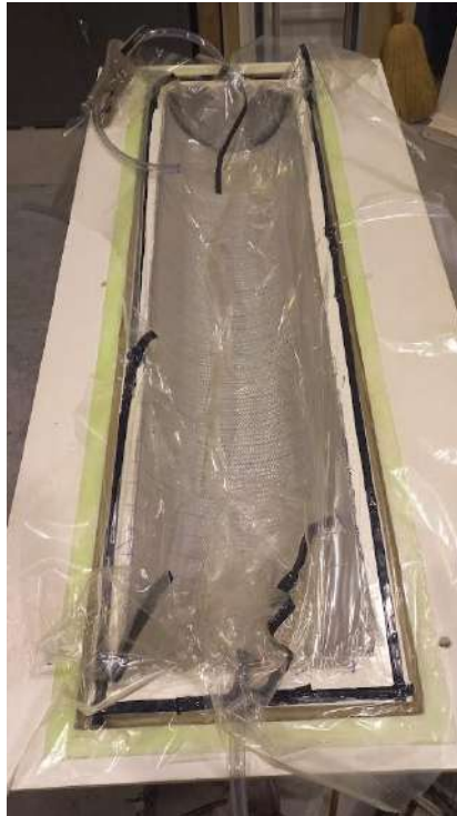
Figura 4.19. Sistema con la bolsa de vacío listo para la infusión.
