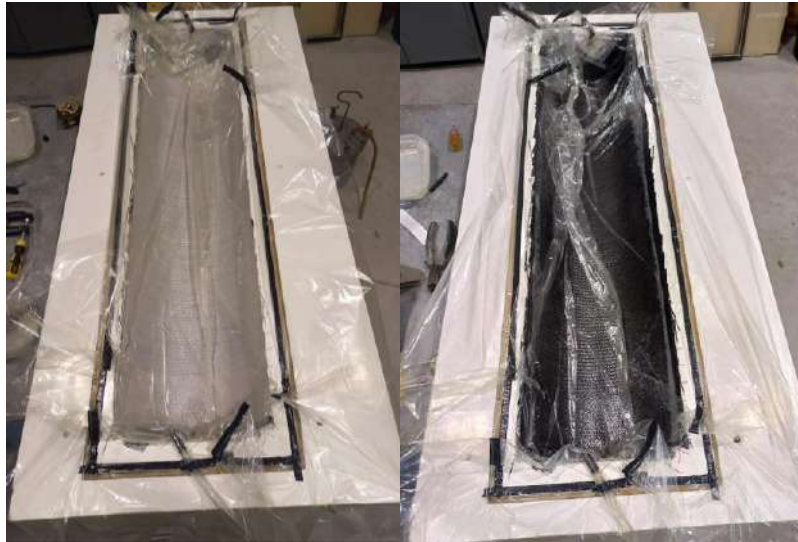
Figura 4.33. (a) Sistema listo para la infusión. (b) Sistema una vez completada la impregnación.
