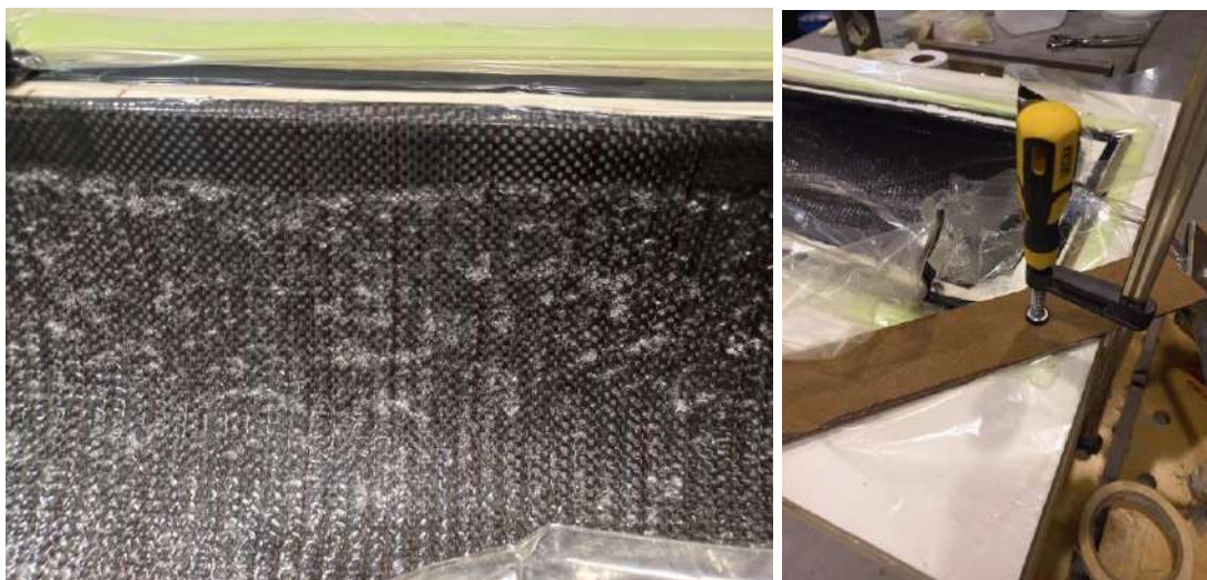
Figura 4.21. (a) Burbujas producto de la pérdida de vacío. (b) Arreglo realizado.
