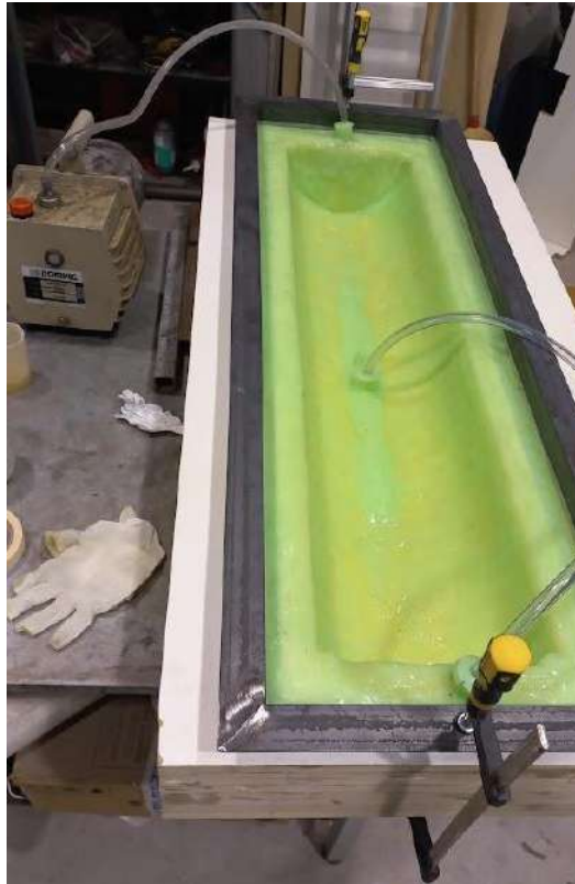
Figura 4.18. Marco de acero colocado sobre el contramolde.
