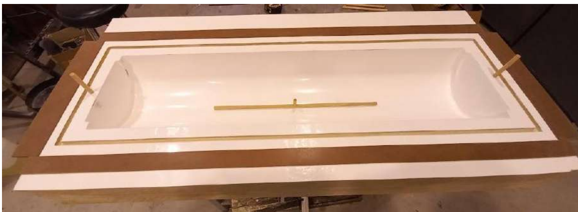
Figura 4.10. Molde preparado para la aplicación de la silicona.
