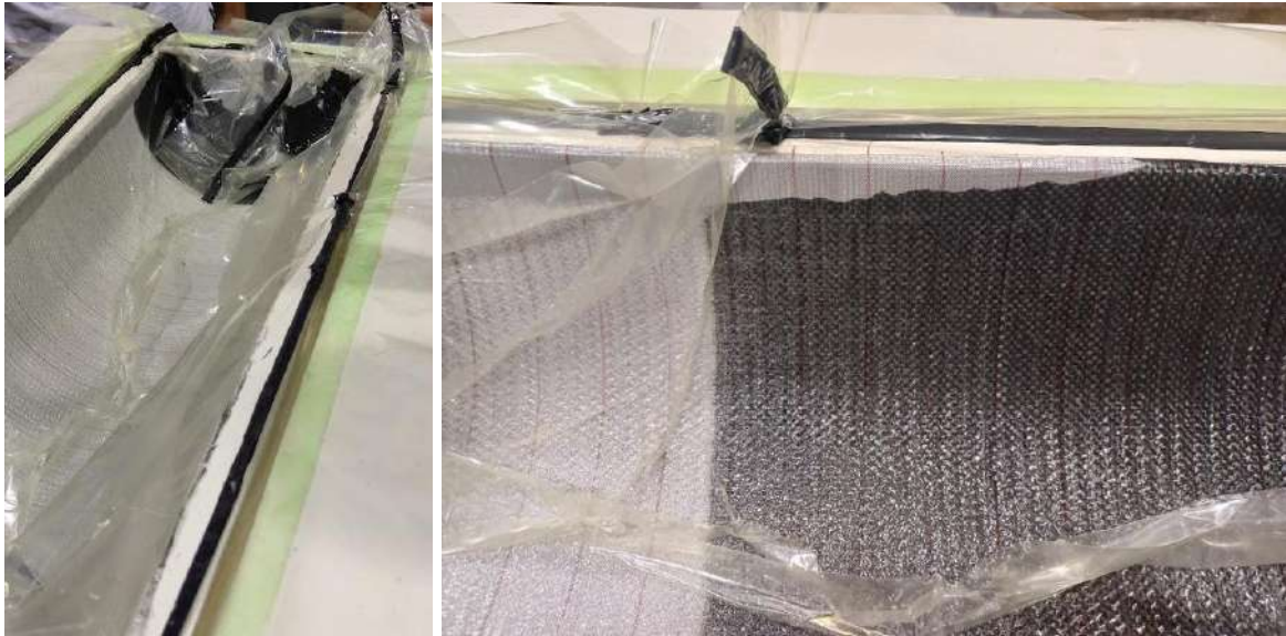
Figura 3.12. Resina ingresando al molde durante la etapa de infusión.
