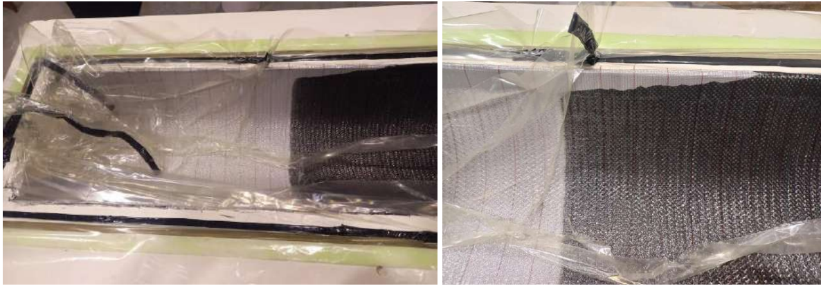
Figura 4.20. (a) Proceso de infusión con la bolsa de vacío. (b) Frente de avance de resina.
