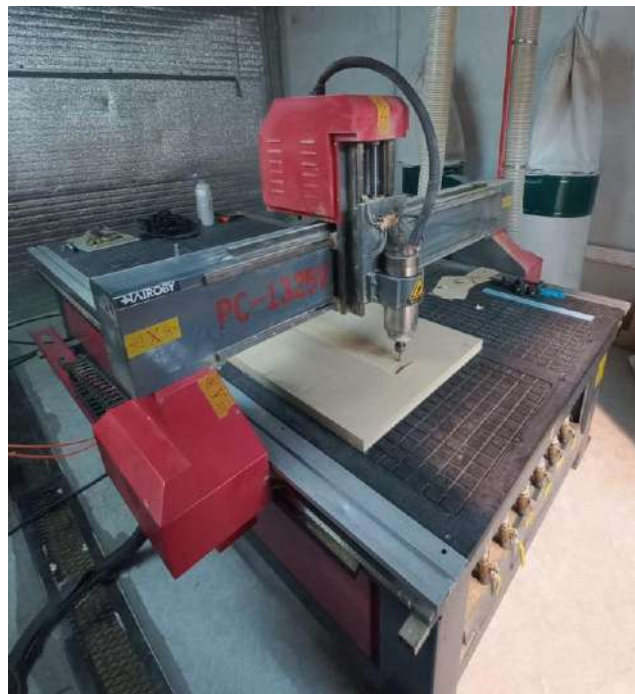
Figura 4.2. Máquina CNC utilizada para la fabricación del molde.
