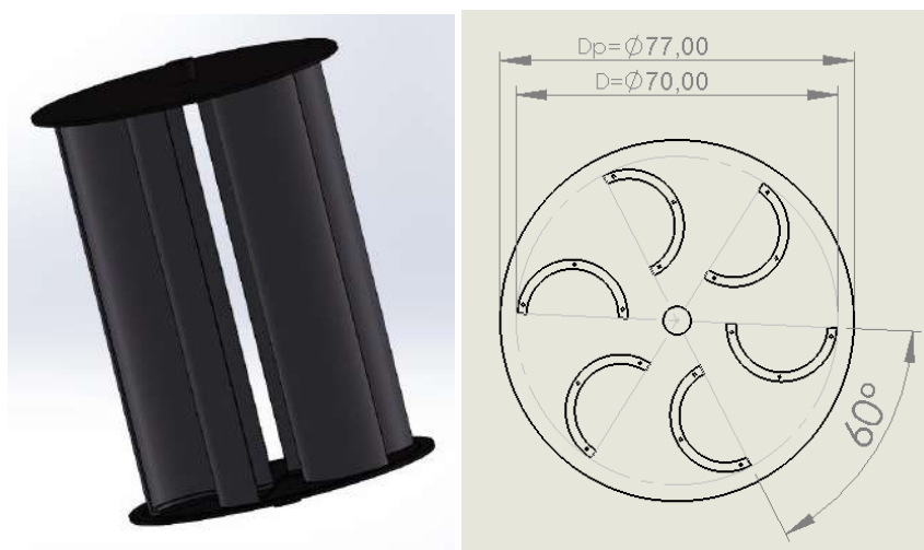
Figura 2.20. (a) Dibujo CAD del rotor ensamblado. (b) Dimensiones del rotor.
