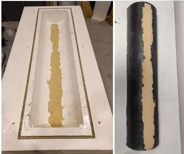
Figura 4.23. (a) Estado del molde luego de quitar la pieza. (b) Porción del molde adherido al aspa.
