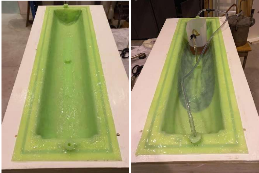
Figura 3.9. (a) Membrana de silicona colocada en el molde. (b) Sistema conectado durante la infusión.
