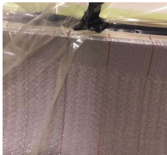
Figura 3.8. Detalle de la posición del flow media .
