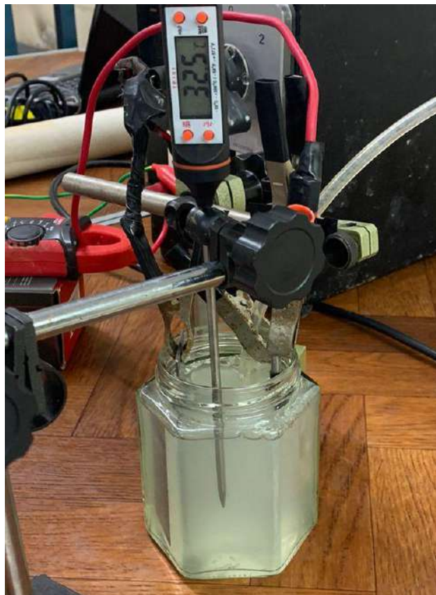
Figura 5.51. Set up del ensayo de electropulido. Sujeción del cátodo y ánodo.
