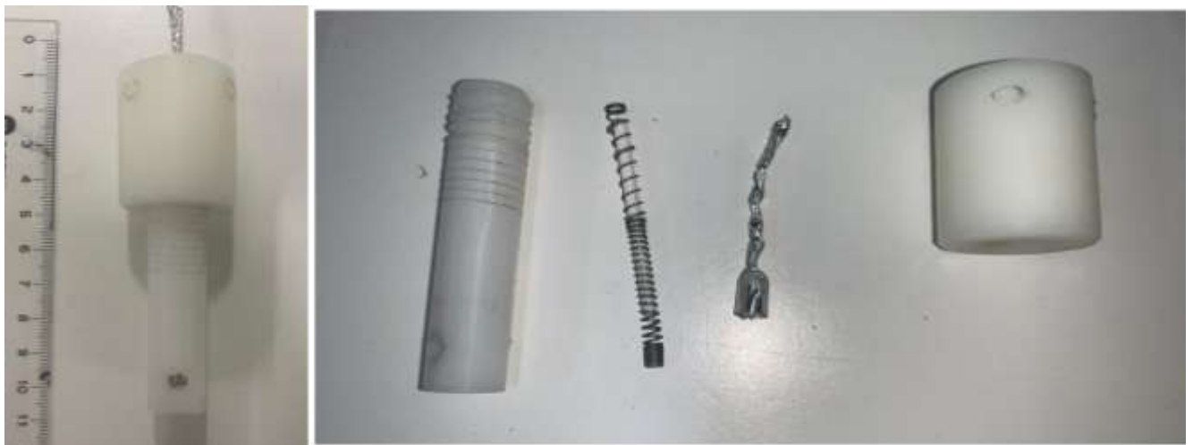
Figura 5.48. Imagen del accesorio porta-probetas para electropulir.
