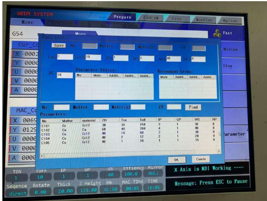
Figura 4.6. Imagen de la pantalla de la electroerosionadora por hilo con las condiciones de ensayo.
