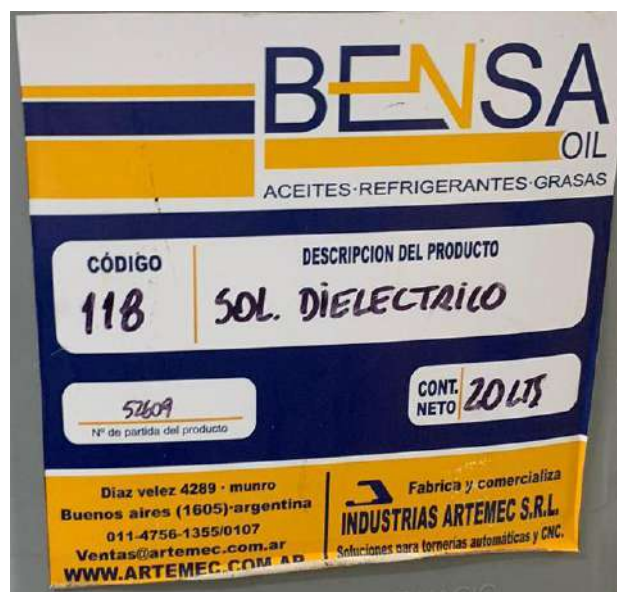
Figura 4.5. Imagen del fluido dieléctrico usado en los ensayos de WEDM.
