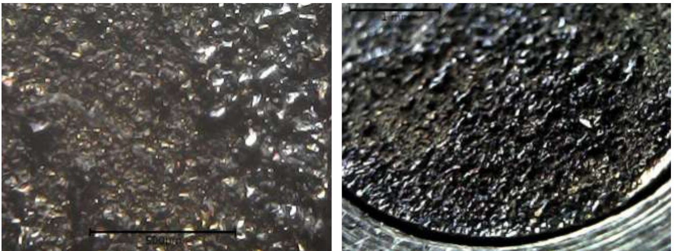
Figura 5.19. Superficie de Ti-6Al-4V (7I) generada por WEDM con nivel de potencia 102. Imágenes tomadas con microscopio USB.
