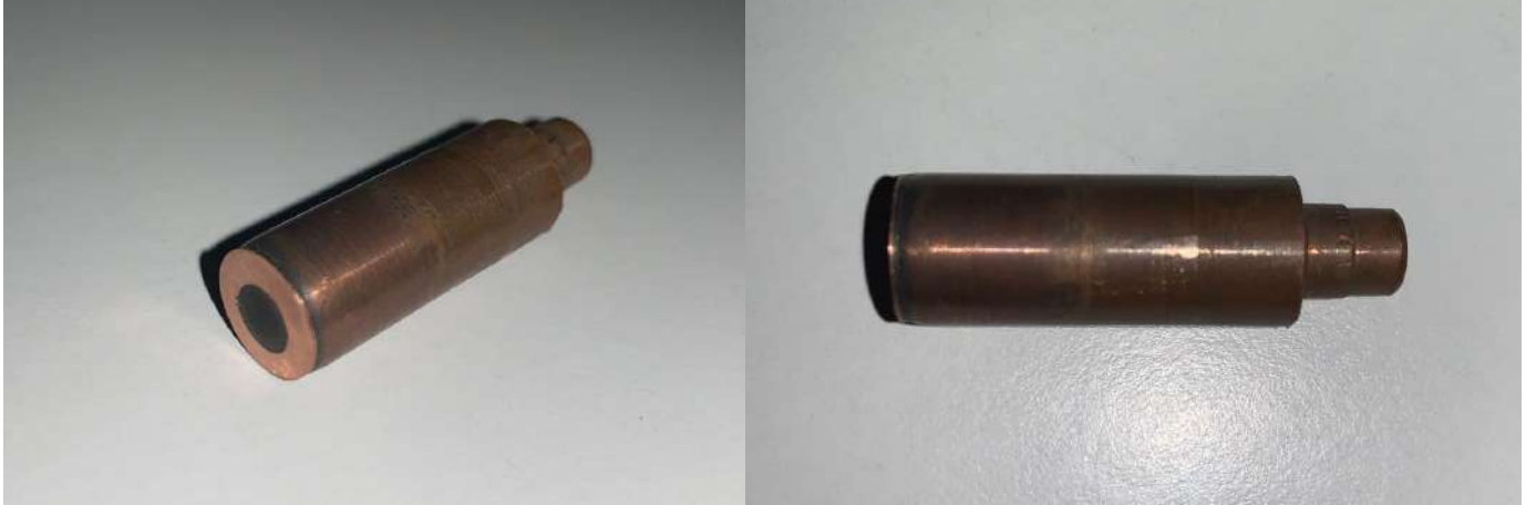
Figura 4.1. Imágenes del electrodo de cobre electrolítico empleado en EDM.
