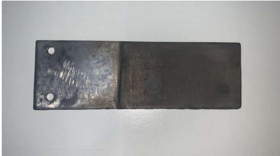
Figura 4.11. Imagen del cátodo de acero inoxidable 304.
