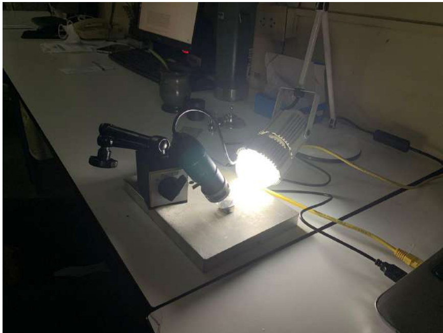
Figura 4.13. Observación de probetas con microscopio óptico USB portátil.
