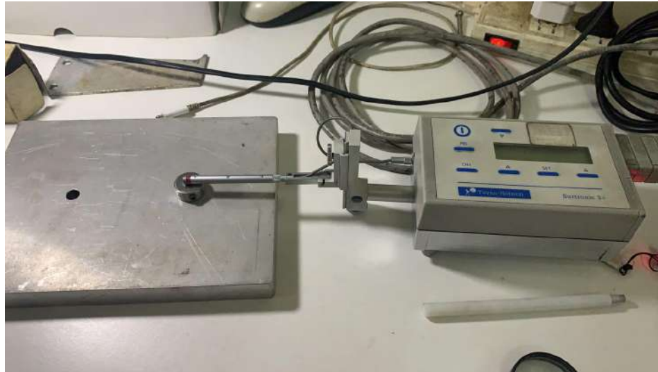
Figura 4.14. Imagen del método de medición de rugosidad mediante perfilometría de contacto.
