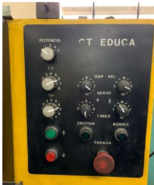
Figura 4.2. Imagen del tablero con las condiciones de ensayo de la electroerosionadora EDUCA 10.
