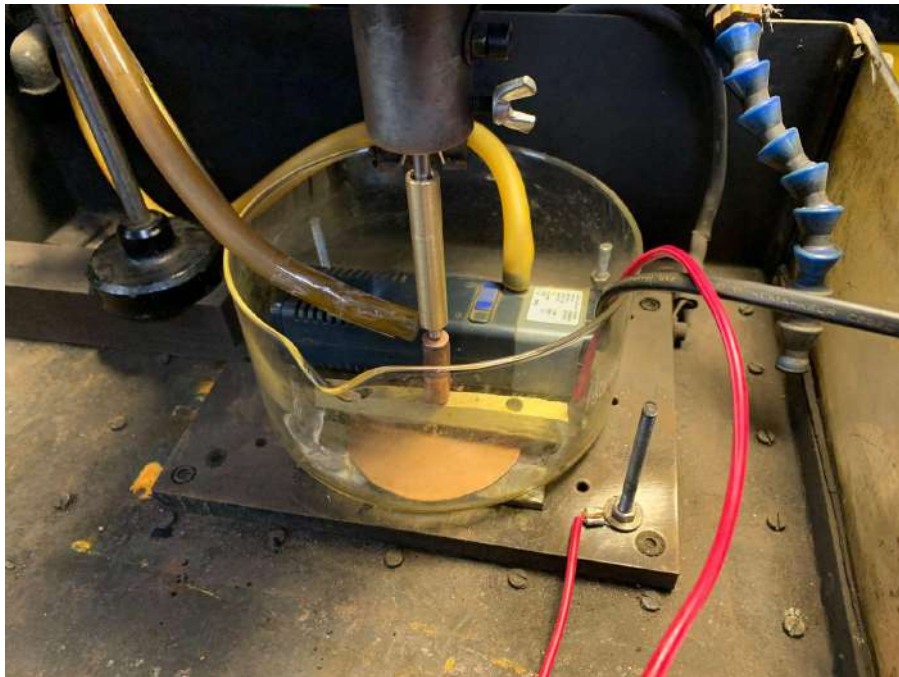
Figura 5.2. Disposición de los elementos usados en la máquina para los ensayos EDM.
