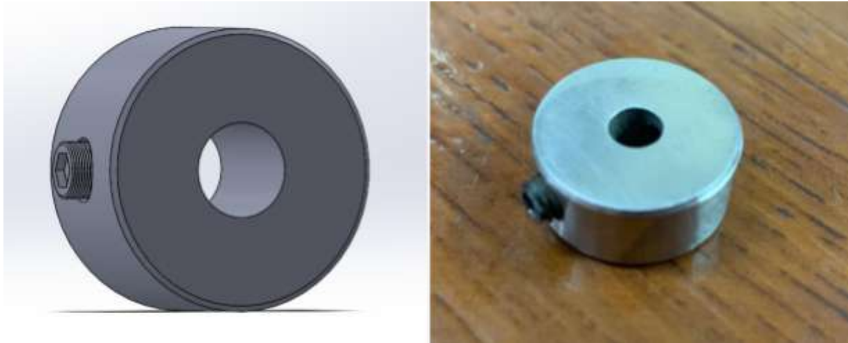
Figura 5.3. Imagen 3D del porta-probetas e imagen del dispositivo fabricado.
