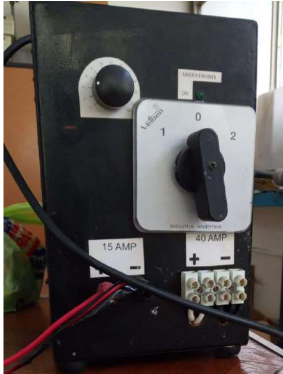
Figura 4.9. Imagen de la fuente de tensión de corriente continua usada para los ensayos de electropulido.
