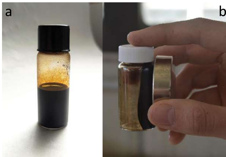
Figura A.1. Suspensión de nanopartículas de óxido de hierro magnético recubiertas con ácido oleico en N-heptano (a) y comportamiento de la misma al acercar un imán (b).
