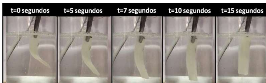
Figura V. 14. Recuperación de forma para una muestra de CPB/PEGDMA.
