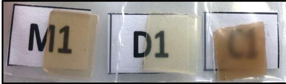
Figura V. 2. Muestras sintetizadas para el ensayo de absorción de agua destilada. A la izquierda, la matriz epoxi, fotocurada. En el centro de la imagen CPB/epoxi al 10% p/p termocurado y a la derecha, el material fotocurado.
