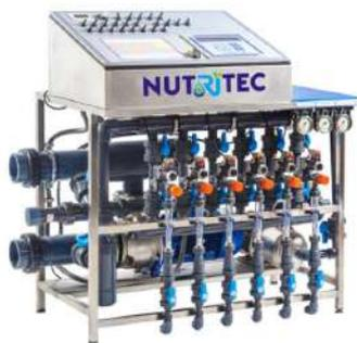
Figura 27: Equipo de control de fertirrigación.
