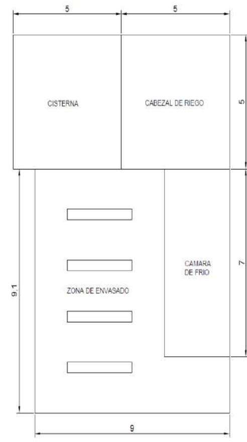
Figura 30: Layout cabezal de riego y zona de envasado.
