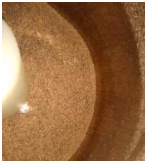
Figura 19. Harina de bagazo obtenida luego de las etapas de molienda y tamizado.
