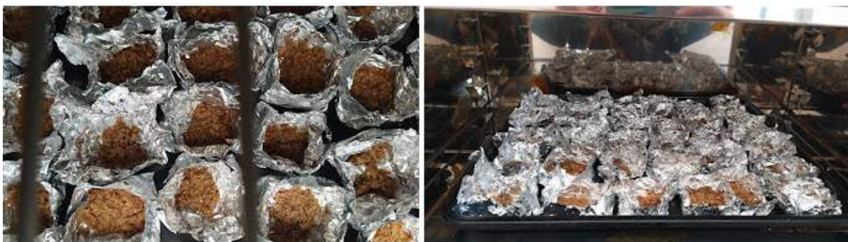
Figura 16. Disposición de las muestras de bagazo en estufa a 105°C.
