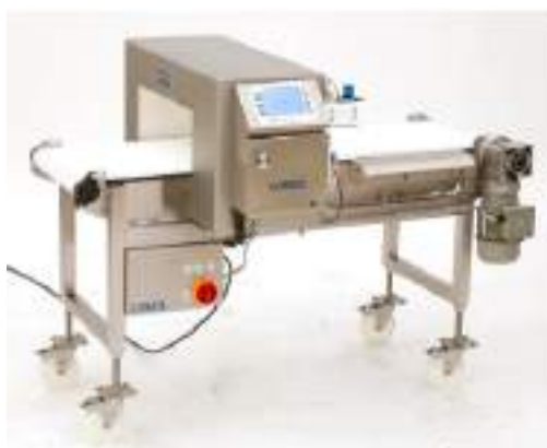
Figura 69. Detector de metales modelo 3.010 (COSO, 2020).
