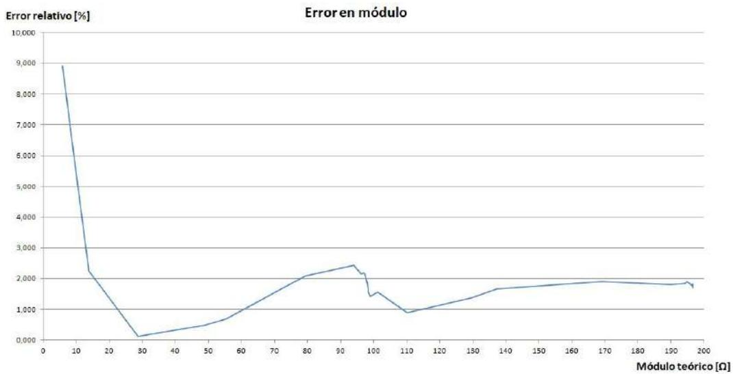
FIGURA 4.20: Comparación entre valor teórico y error relativo del módulo de la impedancia con el equipo.
