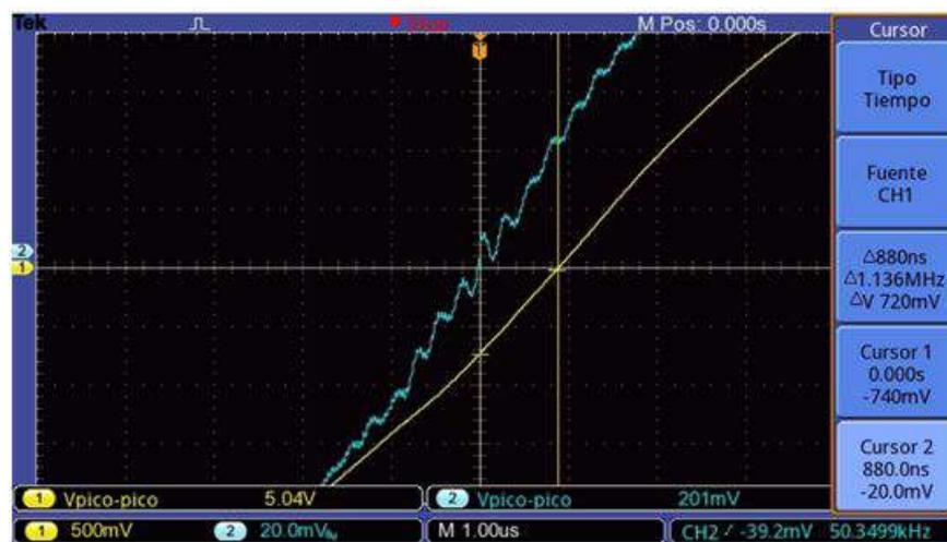
FIGURA 4.6: Señal de entrada (azul) y señal de salida (amarillo) del amplificador de instrumentación para calcular el desfase.
