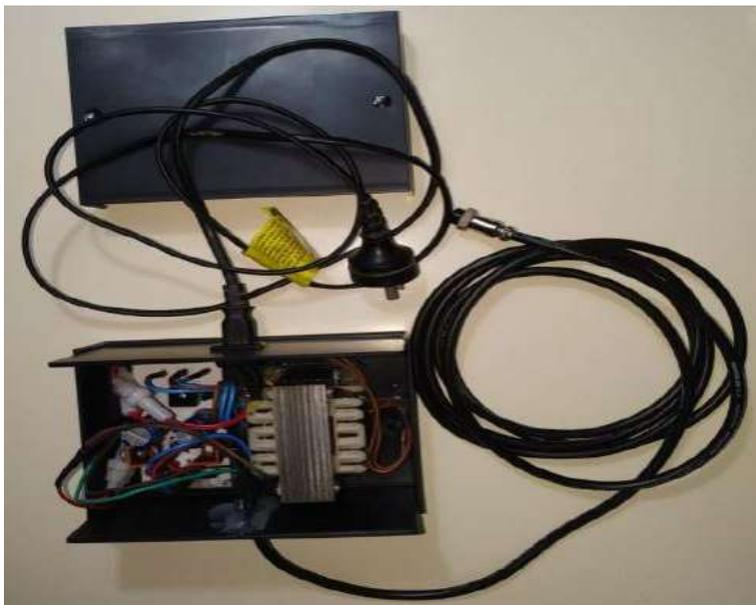
FIGURA C.4: Conexiones fuente de alimentación terminada
