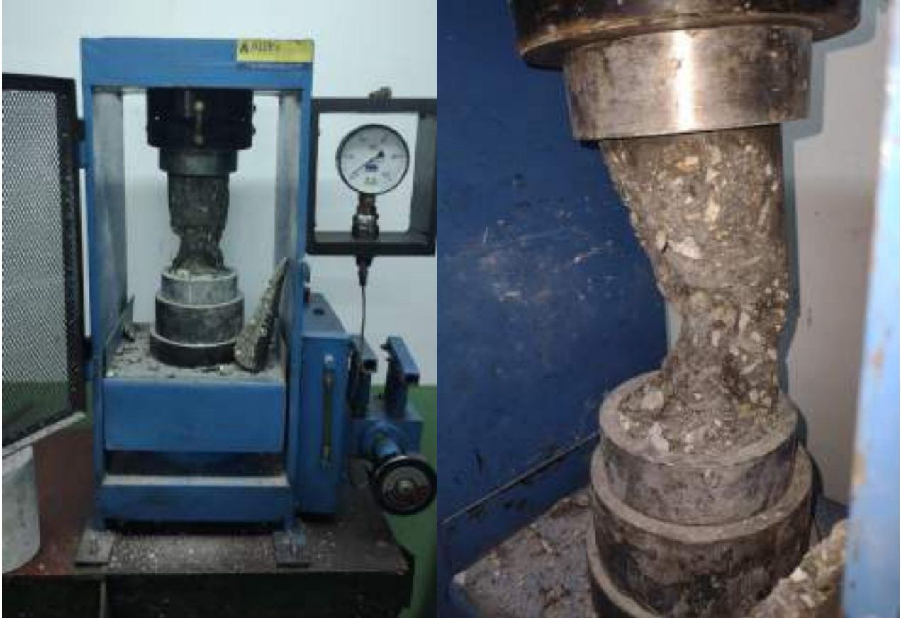
Figura 11A. Ensayo de compresión
