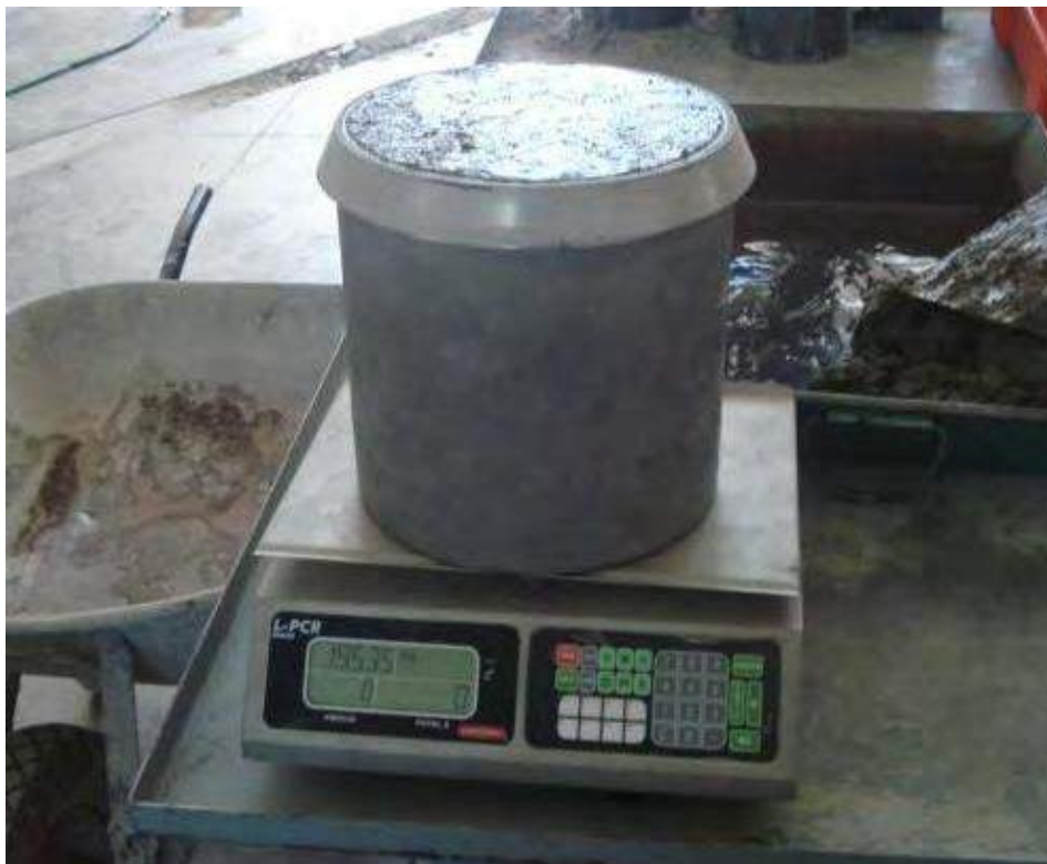
Figura 5A. Recipiente calibrado lleno para obtención de PUV
