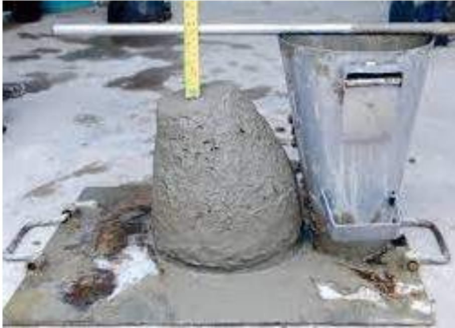
Figura 6A. Medida de asentamiento con cono de Abrams
