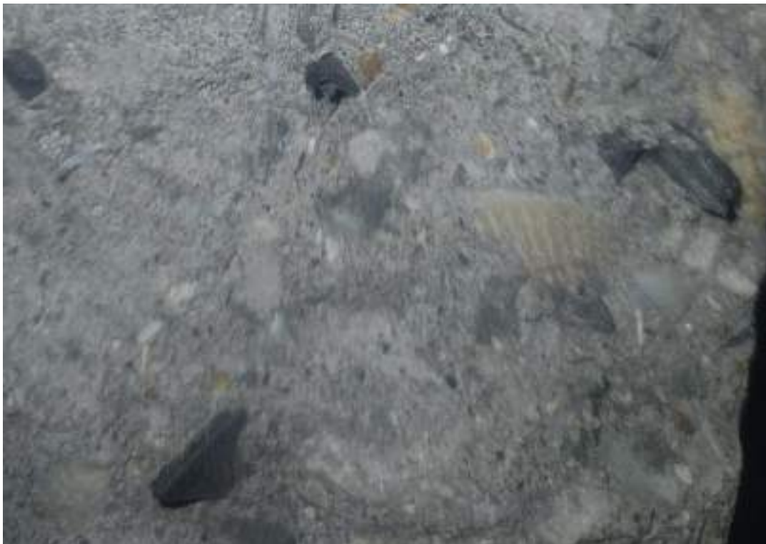
Figura 16. Interfase plástico-pasta cementicia para la muestra H13P10
