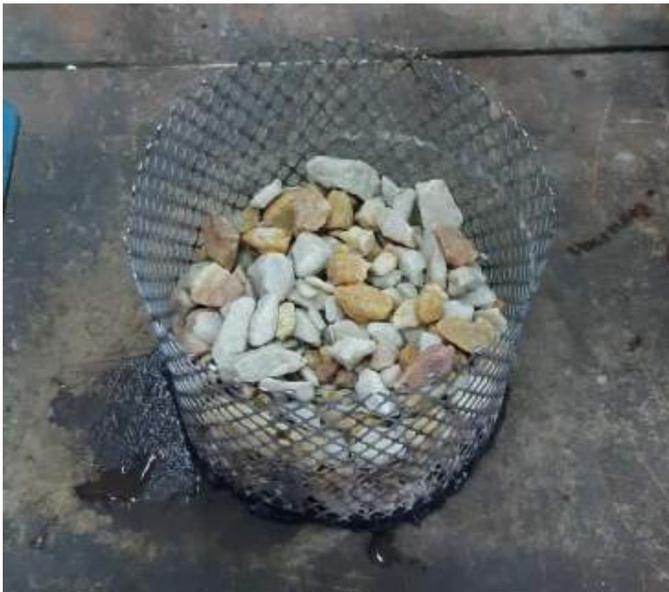
Figura 3A. Muestra en cesta de alambre
