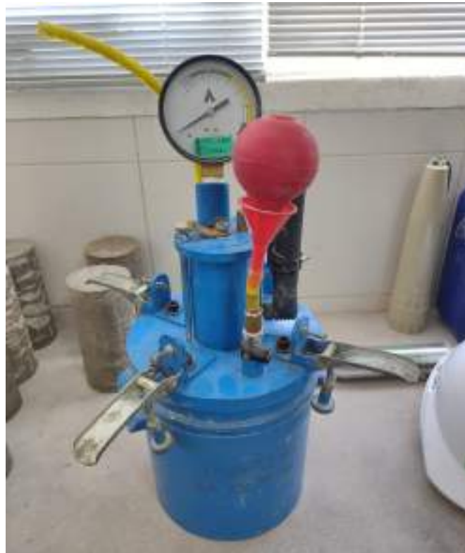
Figura 7A. Recipiente con medidor de aire tipo B
