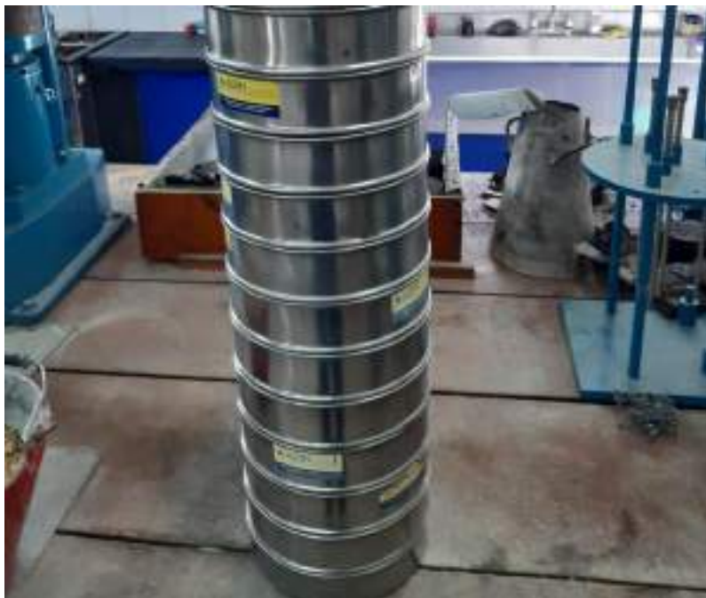
Figura 4A. Tamices normalizados
