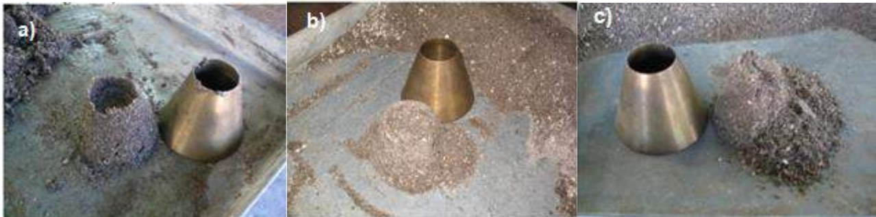
Figura 2A. a) condición saturada; b) condición SSS; c) condición seca
