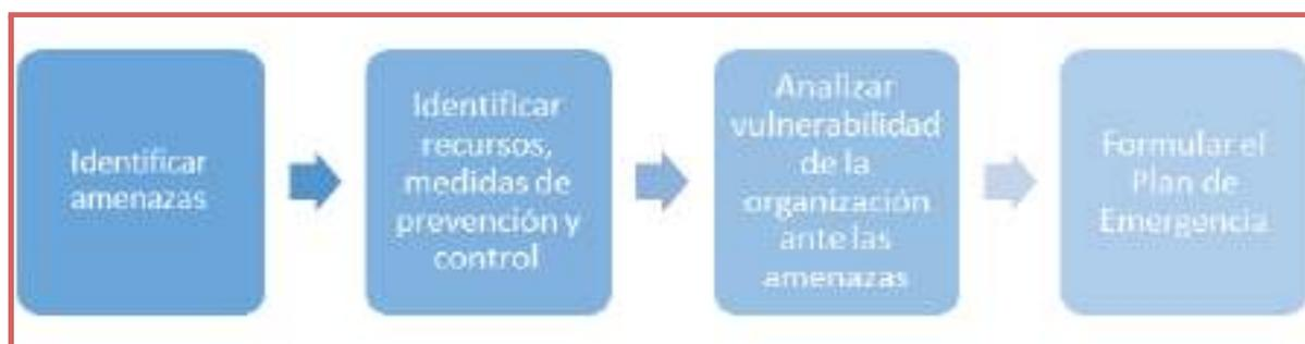
Figura 7.14 - Pasos a seguir para la determinación del Plan de Emergencias.
