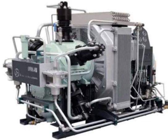
Figura 5.16: Compresor para el reciclo de  $H_2$
