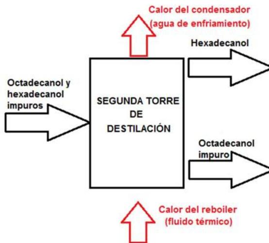
*Figura 7.6: Esquema simplificado de la segunda torre de destilación*
