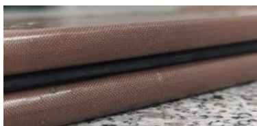
Figura 2.2. Molde de aluminio recubierto con Teflón, con separadores de goma
