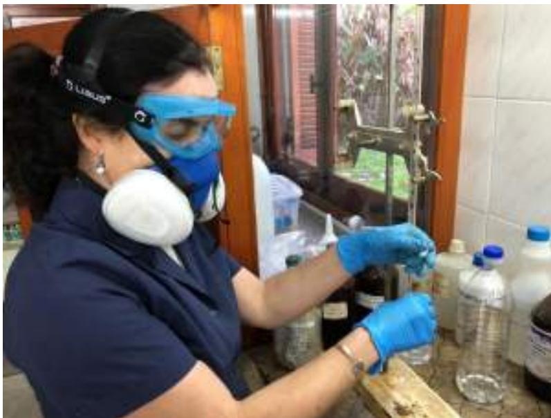
Ilustración 28: Personal de laboratorio con los EPP trabajando bajo la cabina de extracción de gases. Fuente: propia.
