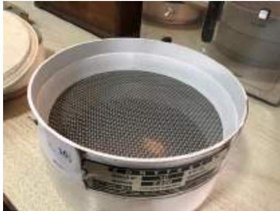
*Ilustración 19: Tamiz de 2mm para tamizado de la muestra. Fuente: propia.*
