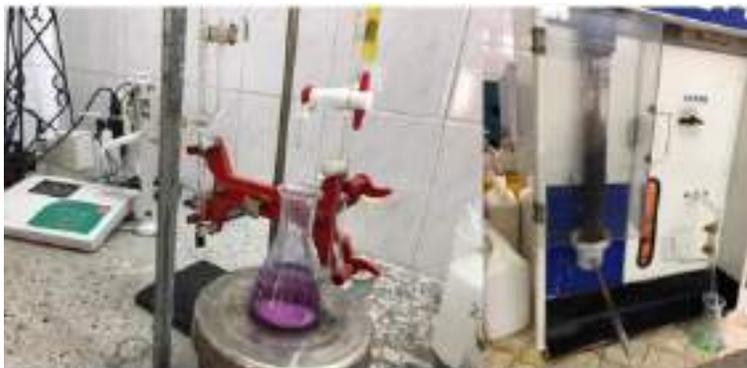
Ilustración 26: Equipamiento para análisis método Kjeldhal. Fuente: propia.
