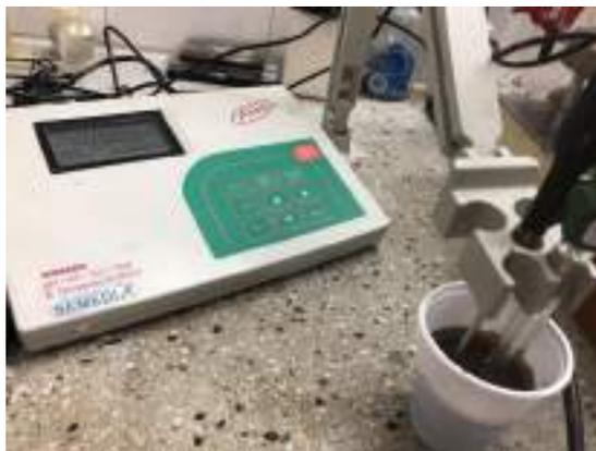
Ilustración 25: Equipamiento para medir pH y CE. Fuente: propia.
