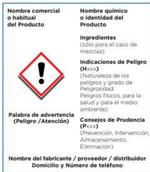
Ilustración 3: Formato y contenido de la etiqueta de los envases químicos. Fuente: SGA
