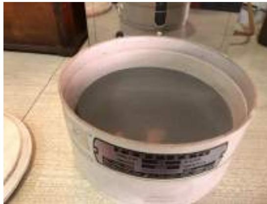
*Ilustración 20: Tamiz de 5 mm para tamizado de la muestra. Fuente: propia.*
