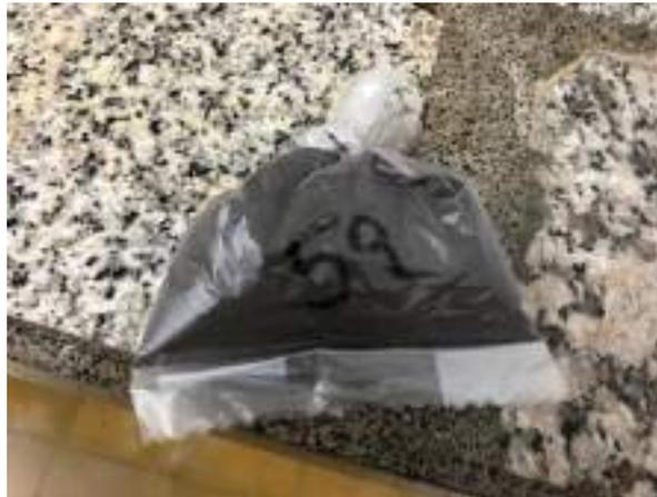
*Ilustración 21: Muestra de suelo molida, secada y tamizada. Lista para analizar. Fuente: propia.*
