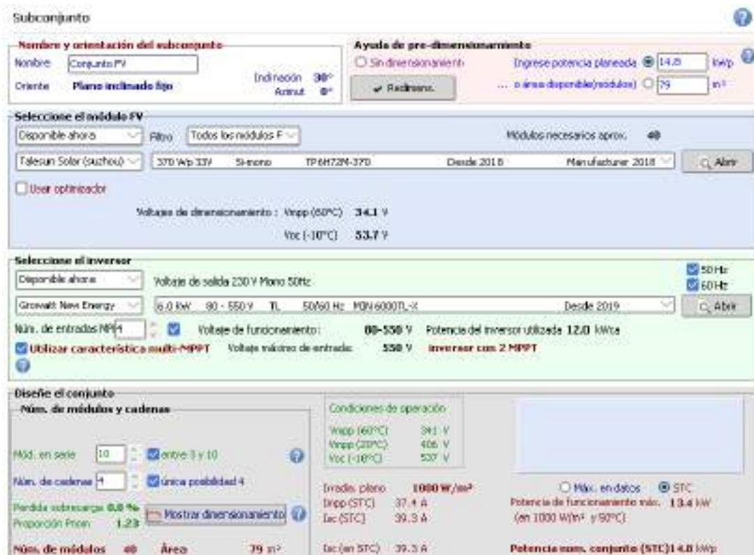
Figura 4.14: Interfaz de PVSyst para indicar modelos de módulos fotovoltaicos e inversores.
