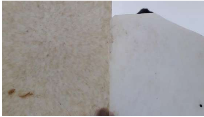
Figura 4-12. Placas de material virgen secadas por IR y por Estufa
