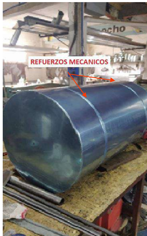
Figura 3-13. Cilindro de acero inoxidable 304L.
