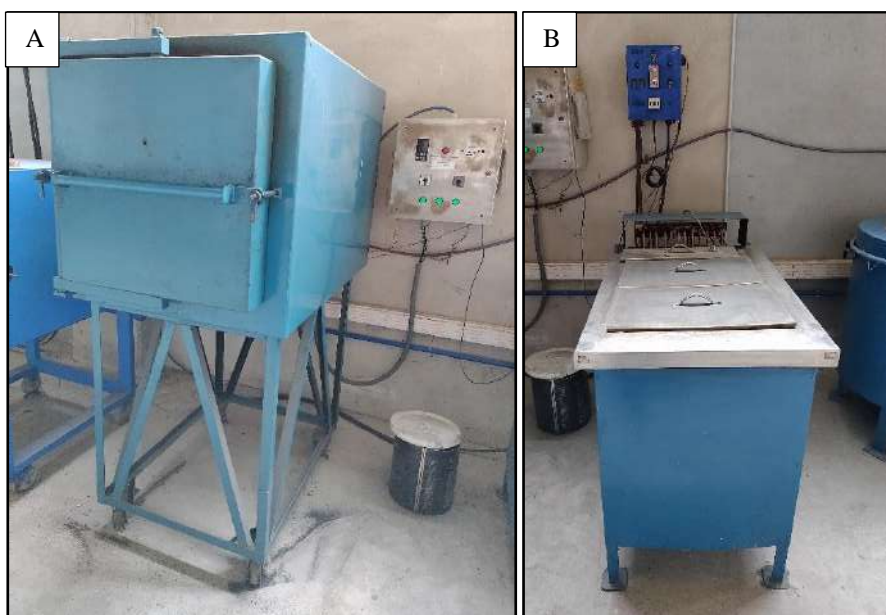
Fig. 3-3: Hornos utilizados para desarrollar los ciclos de tratamientos térmicos. (A) Mufla eléctrica utilizada para la etapa de austenizado, (B) horno de sales utilizado para la etapa de austemperado.
