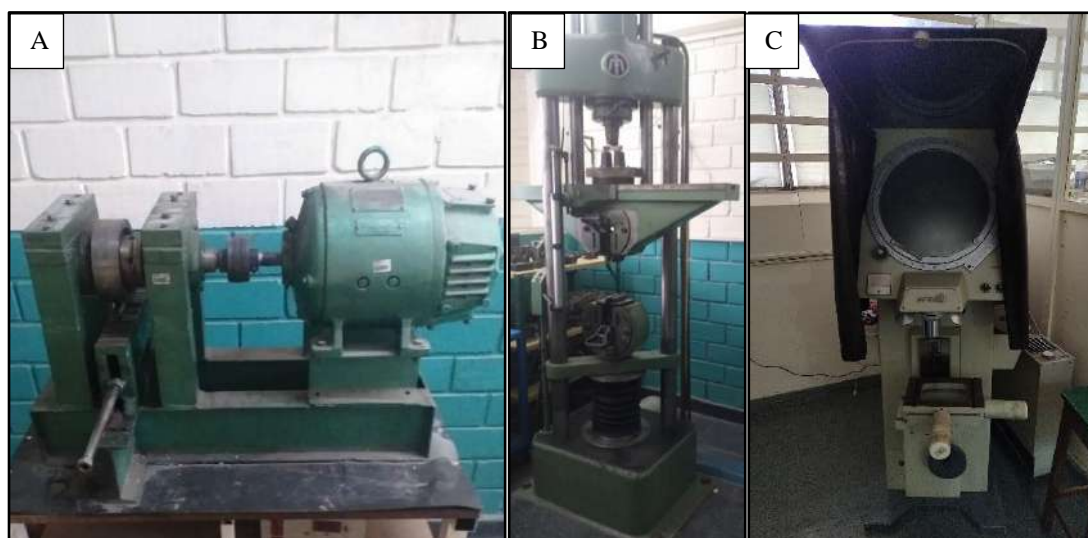
Fig. 4-4: Máquina de fatiga (A). Máquina Mohr Federhaff (B). Proyector de perfiles (C).
