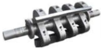
**Figura 5.8.** Sistema de cuchillas.
