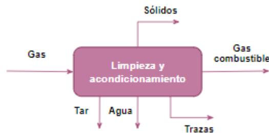
Figura 4.13. Diagrama del sistema de limpieza y acondicionamiento del gas.
