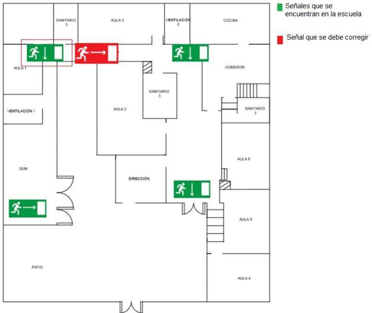
Figura 5: Señalización de las puertas de emergencia. Fuente: Elaboración propia
