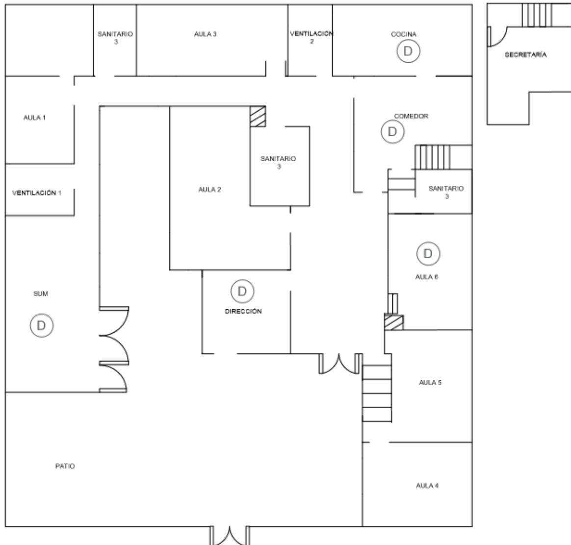
Figura 13: Disposición de los detectores de humo. Fuente: Elaboración propia
