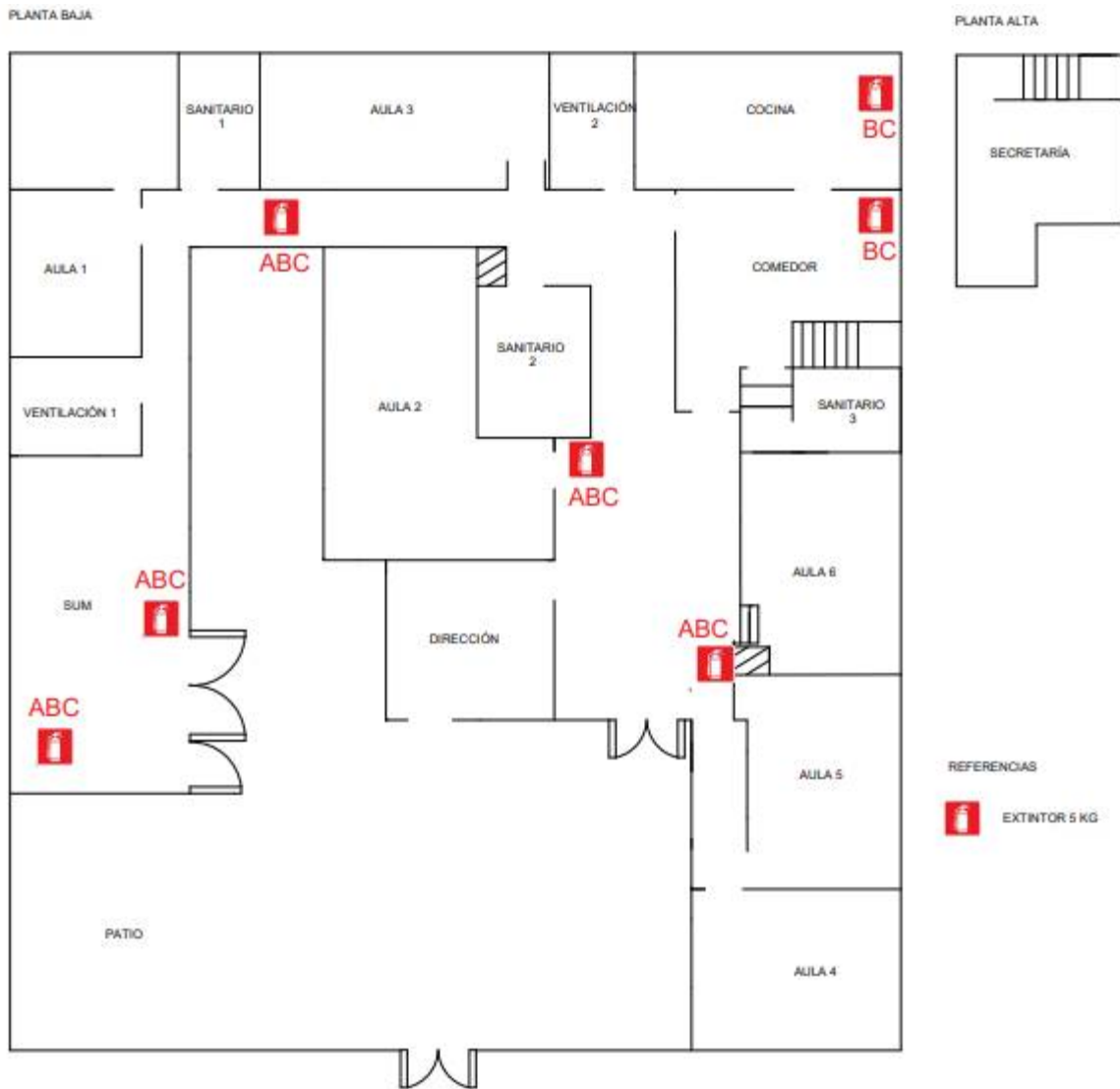
Figura 16: Plano con la ubicación de los extintores según la propuesta de mejora. Fuente: Elaboración propia
