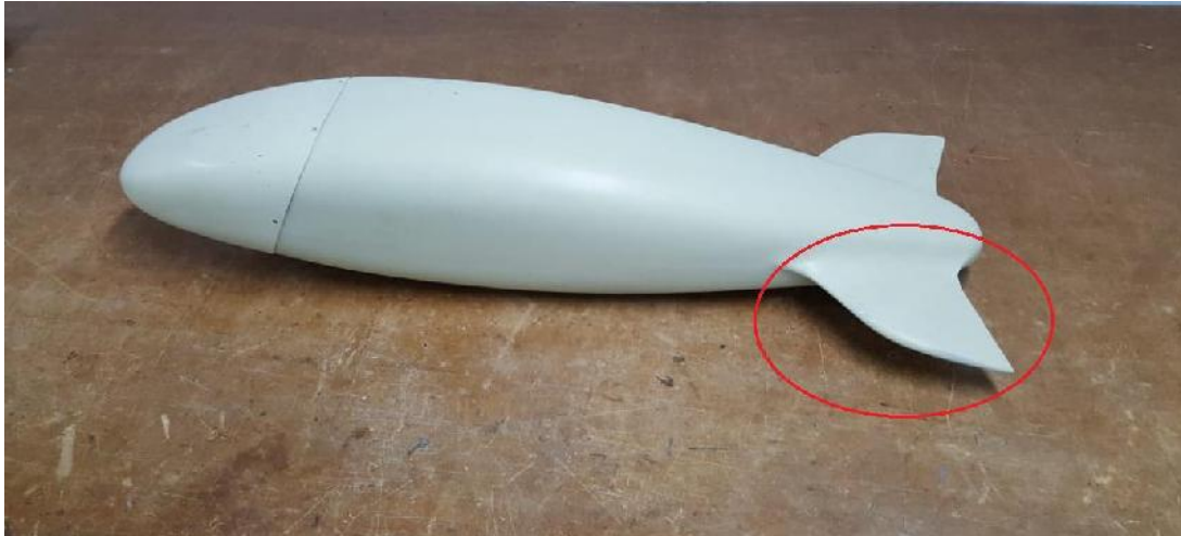
Figura 94: Diseño Primario de Depósito de Tanque con Aletas Fijas. Las Mismas Migraron a Elementos Intercambiables.
