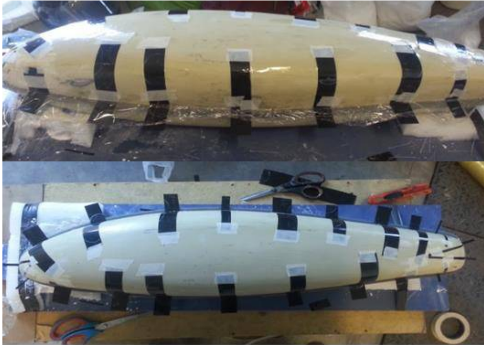
Figura 76: Modelo Lubricado con Aceite vegetal y Recubierto en Film de Polietileno más Segmentos de Papel Acetato.
