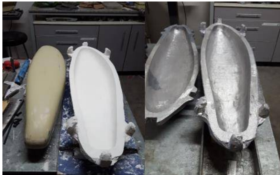
Figura 80: Molde en Yeso con sus Guías, y su Análogo en Aluminio. Las Guías Fueron Reemplazadas por Clavijas.
