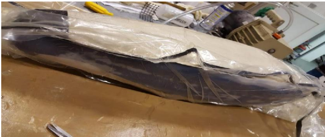
Figura 91: Asistencia de Vacío ("Vacuum bagging molding").
