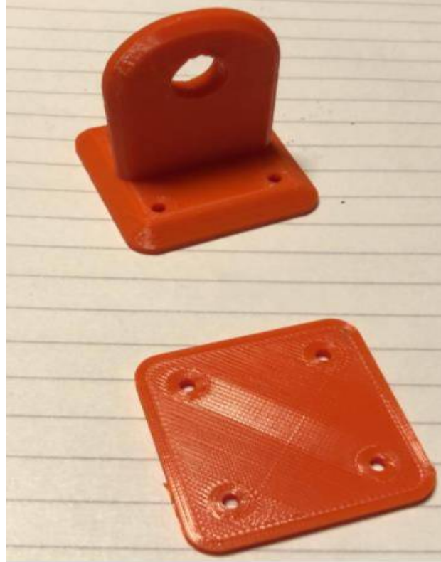
Figura 98: Anclajes Impresos 3D
