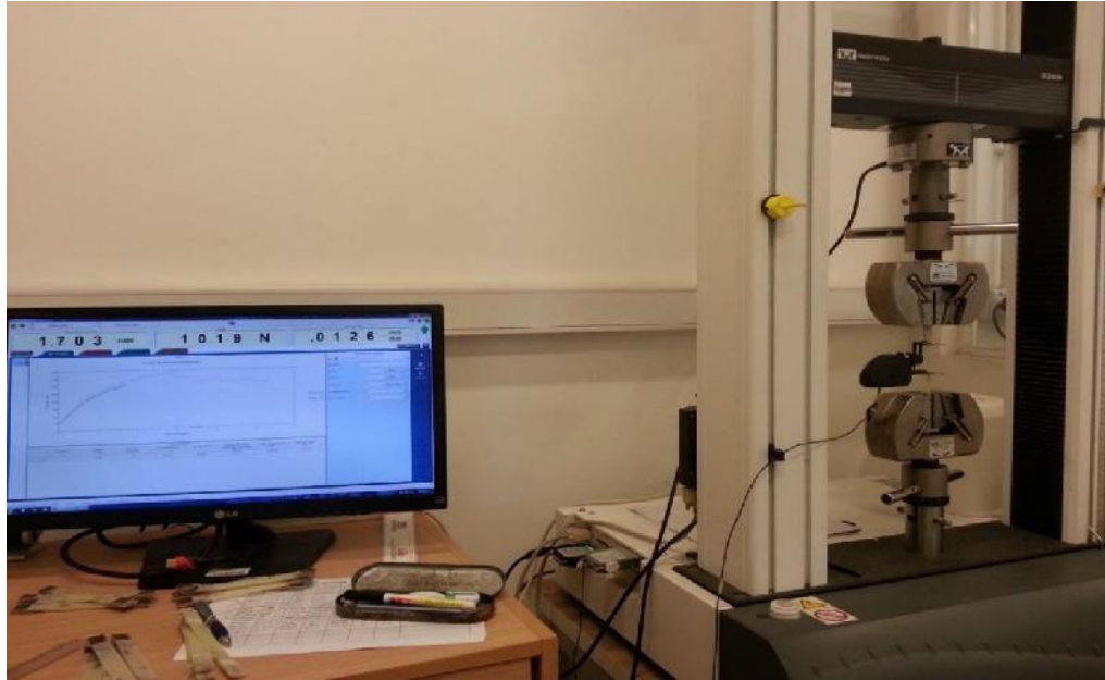
Figura 34: Ensayo de Tracción Uniaxial con Extensómetro. INSTRON 3369. INTEMA – UNMDP.
