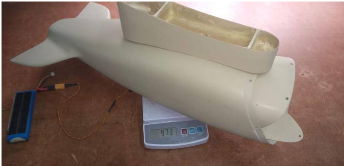
Figura 103: Contenedor de Tanque (Diseño Primario).
