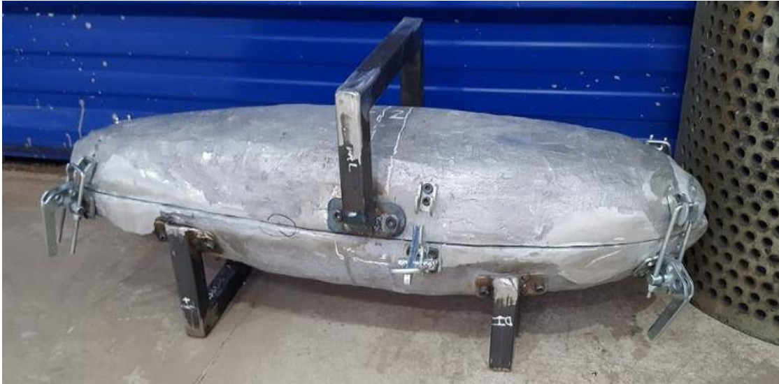
Figura 84: Vista del Conjunto Armado Donde se Aprecia Arnés Inferior, Arnés Superior y Cierres TR – 34.
