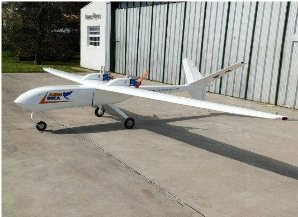
Figura 29: Vista General de la Aeronave con sus 3,80 m de Longitud, 1,20 m de Altura y 6,50 m de Envergadura.
