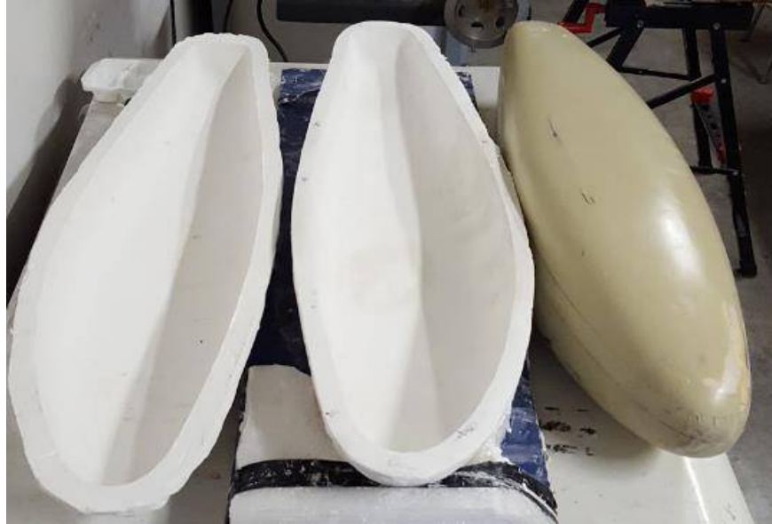
Figura 79: Mitades Obtenidas y Planos Medios Trabajados Abrasivamente.
