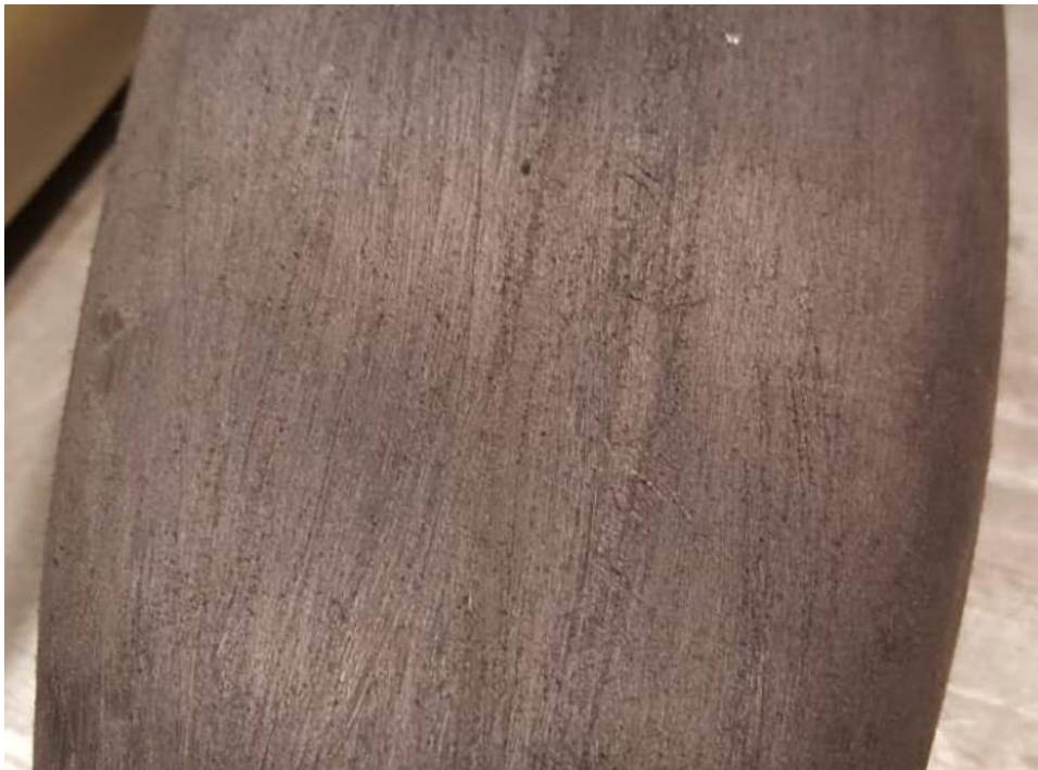
Figura 88: Rayado Superficial Para Aumentar la Adhesión Termoplástico/Termorrígido.
