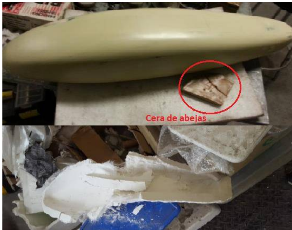
Figura 74: Modelo Encerado con Cera de Abejas y Producto Obtenido Desechado.
