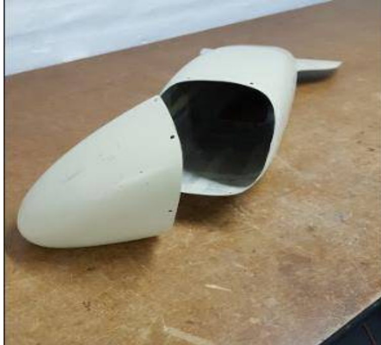
Figura 24: Acceso al Compartimiento Contenedor del Tanque.
