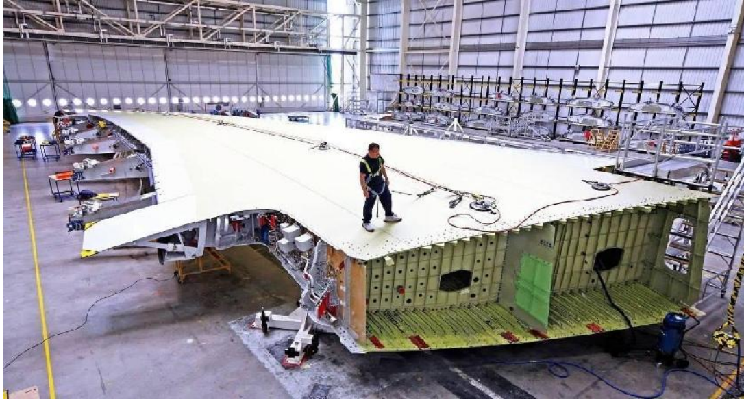
Figura 16: Tanque Integral “Ala Húmeda” de un BOEING 747-400.
