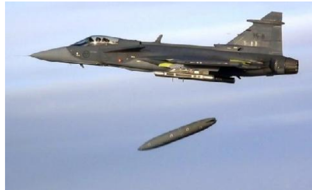
Figura 20: "Drop Tank" Desvinculado en Vuelo.
