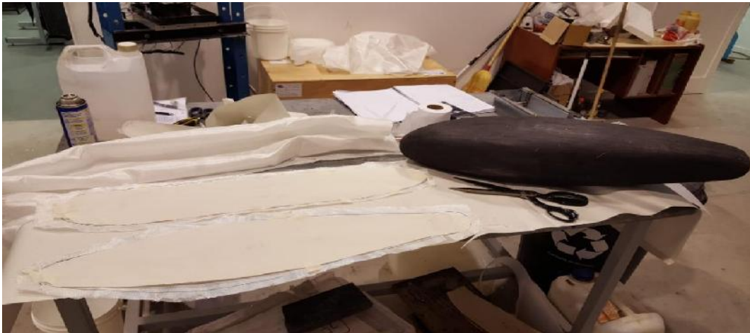
Figura 90: Elaboración de Moldes de Fibra con los Lados del Tanque.
