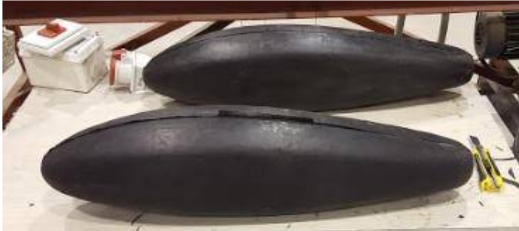
Figura 86: Operación de Recortes de Primera y Segunda Prueba. Vista Lateral Tanque 1,5 Kg.
