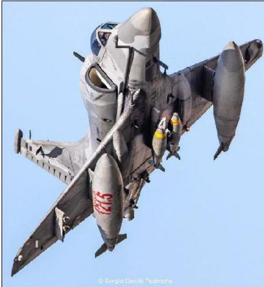
Figura 19: Vista General de "Drop Tanks" y sus Aletas Anti – Vórtices.
