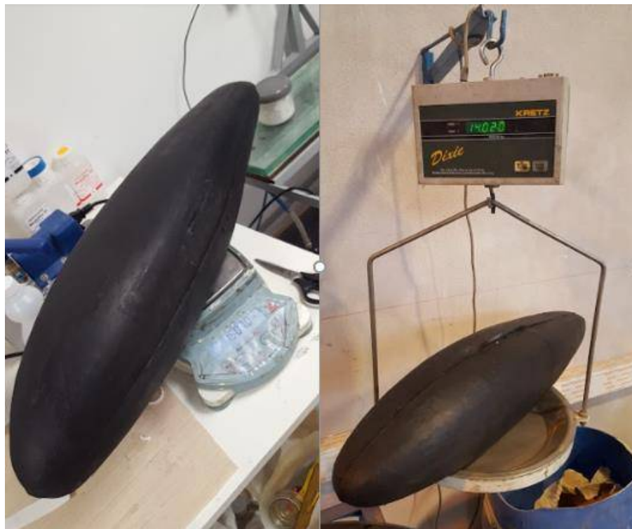
Figura 87: Tanque de 1,5 Kg. Peso en Vacío: 1,507 Kg, Peso Lleno: 14,020 kg.
