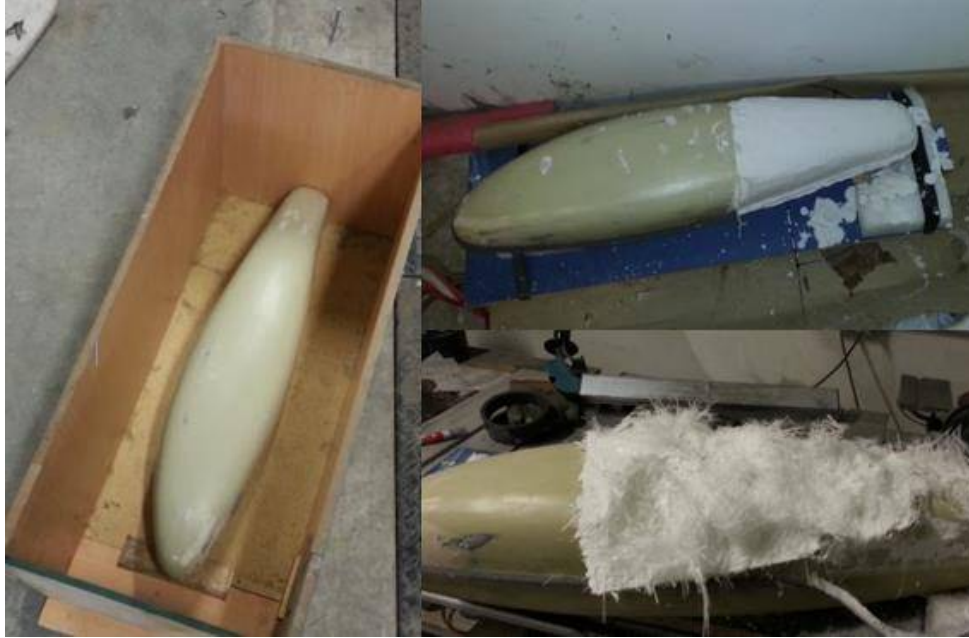
Figura 72: En las Imágenes se Puede Apreciar el Moldeo en Cajón (Opción Rechazada) y las Primeras Pruebas con Resultado Negativo en la Dosificación de Yeso.
