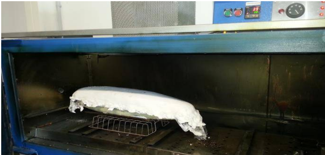
Figura 78: asistencia térmica para el fraguado en horno con control de temperatura.
