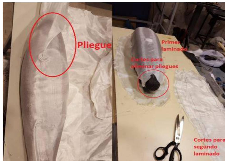
Figura 89: Preparación de Fibra de Vidrio Para Primer y Segundo Laminado.
