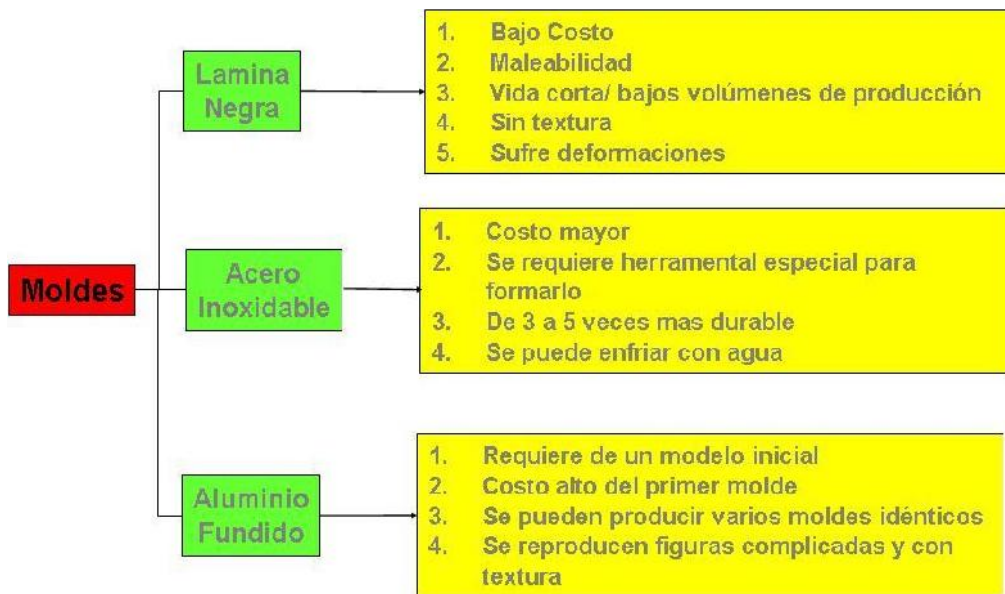
Figura 9: tipos de moldes de rotomoldeo más comunes en la industria.
