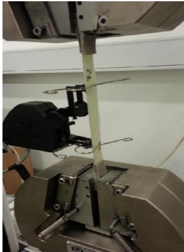
Figura 35: Probeta y Extensómetro de 25 mm en Ensayo de Tracción Uniaxial, INSTRON – 3369, INTEMA – UNMDP.
