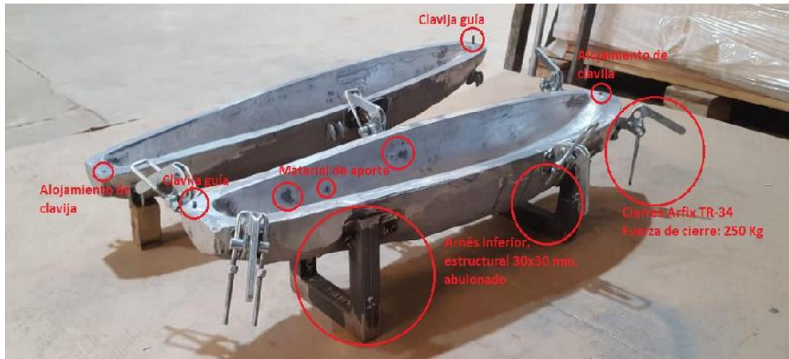
Figura 82: Modificación de Guías por Clavijas / Arnés Inferior / Fijadores TR-34 Marca ARFIX.
