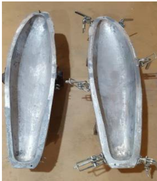
Figura 83: Vista del Interior del Molde Terminado.
