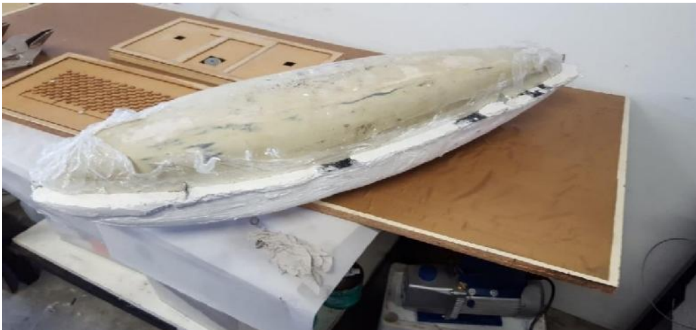
Figura 77: Molde con Modelo a Desmoldar. Se Puede Apreciar el Papel Film y Segmentos de Acetato que Sirvieron para Desmoldar la Pieza. Se Observa También la Arista a 90° Generando el Plano Medio de la Pieza.
