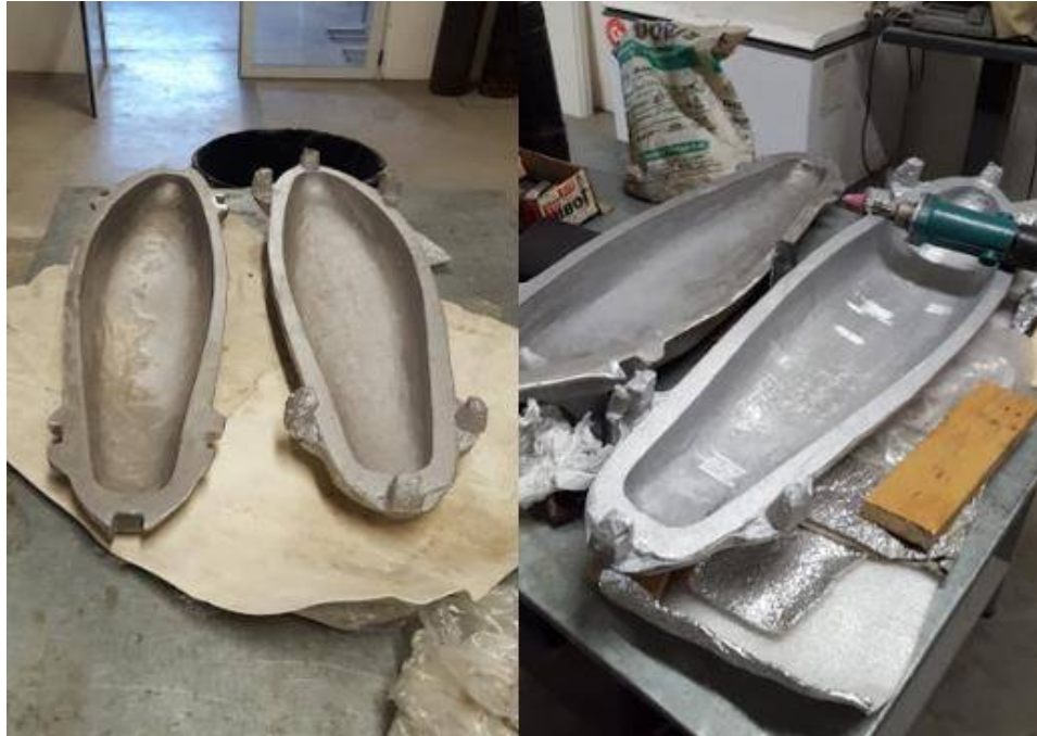
Figura 81: Molde Obtenido y Optimización del Acabado Superficial y Bordes.
