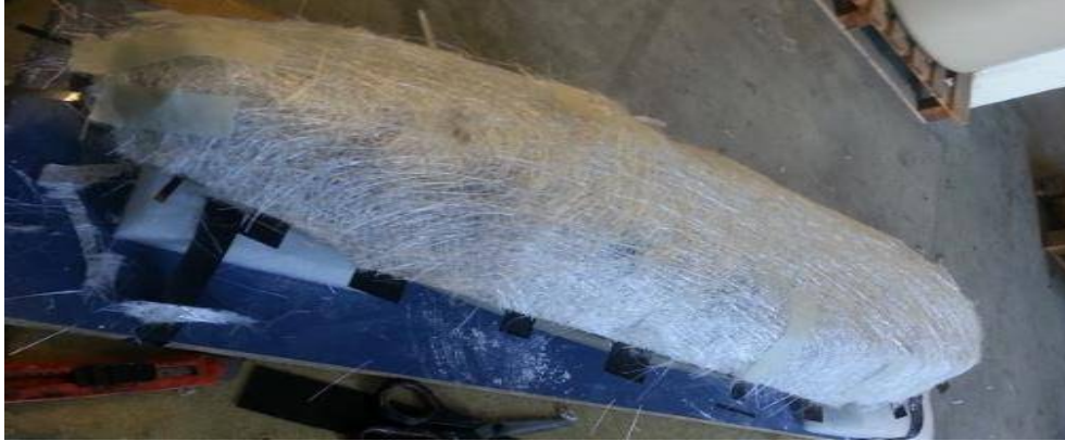
Figura 73: Refuerzo de Fibra de Vidrio Intermedio al Yeso.
