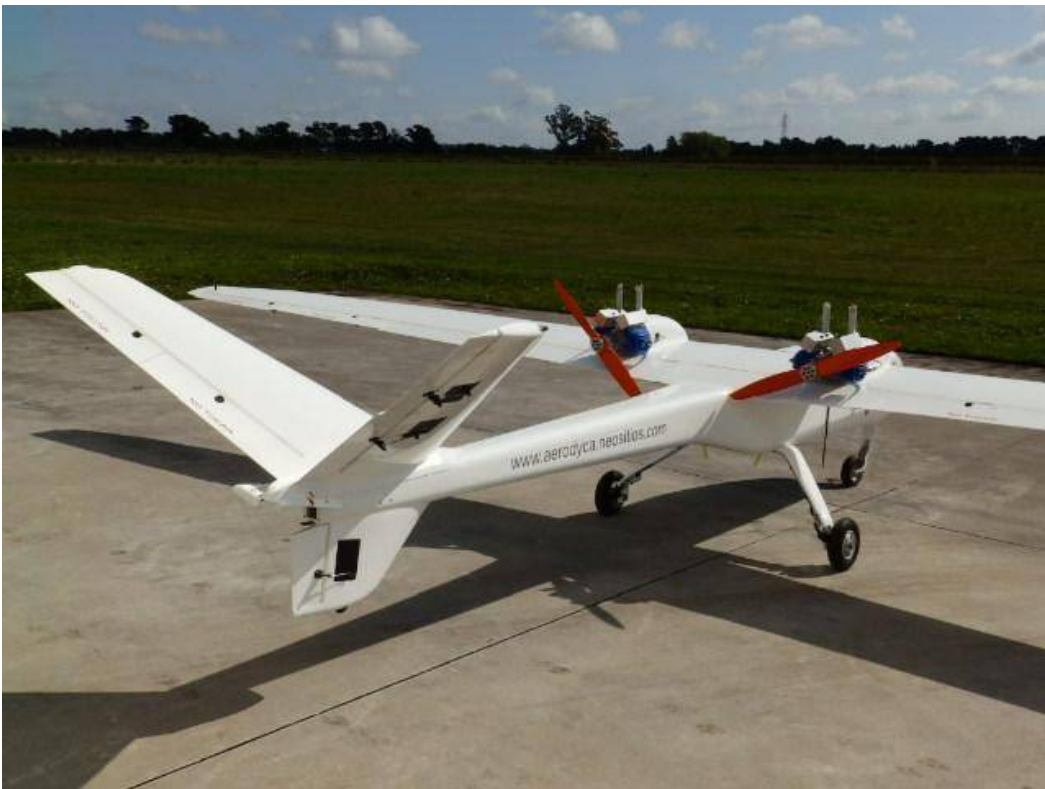
Figura 27: Vista Anterior de la Aeronave con su Estabilizador Vertical Tipo "V" y su Doble Propulsión de 12 HP Cada Uno.
