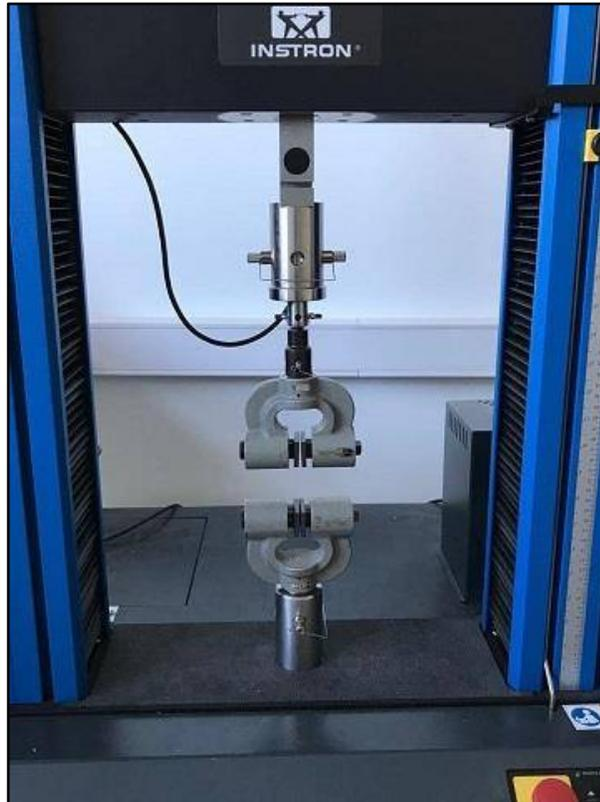
Figura 13. Máquina de ensayos universales Instron 4467.
