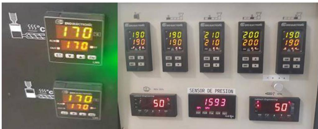
Figura 35. Ilustración de las temperaturas de tornillo utilizadas en la “Condición Fuerte”.
