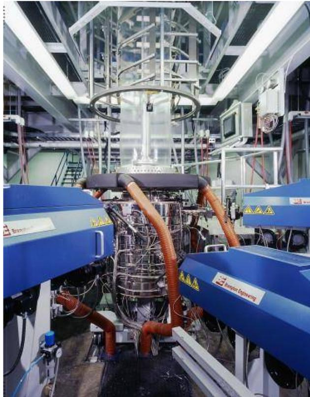
Figura 7. Equipamiento para coextrusión-soplado de película multicapa de nueve capas [16].
