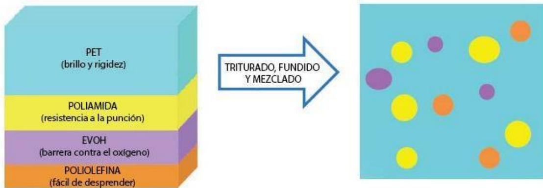
Figura 9. Esquemmatización del producto obtenido a partir del reciclado mecánico de una película multicapa. Adaptado de [23].
