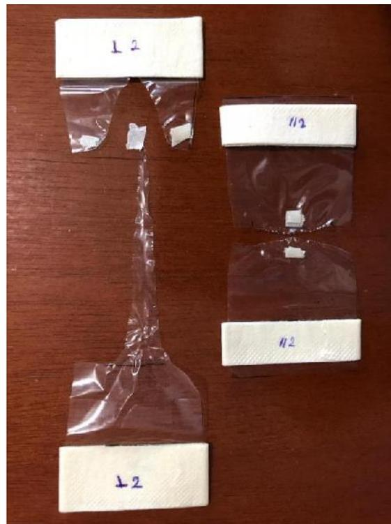
Figura 50. Probetas post-mortem de PE en dirección paralela (izquierda) y transversal (derecha), ambas con relación  $\frac{a}{L}=0,3$ .
