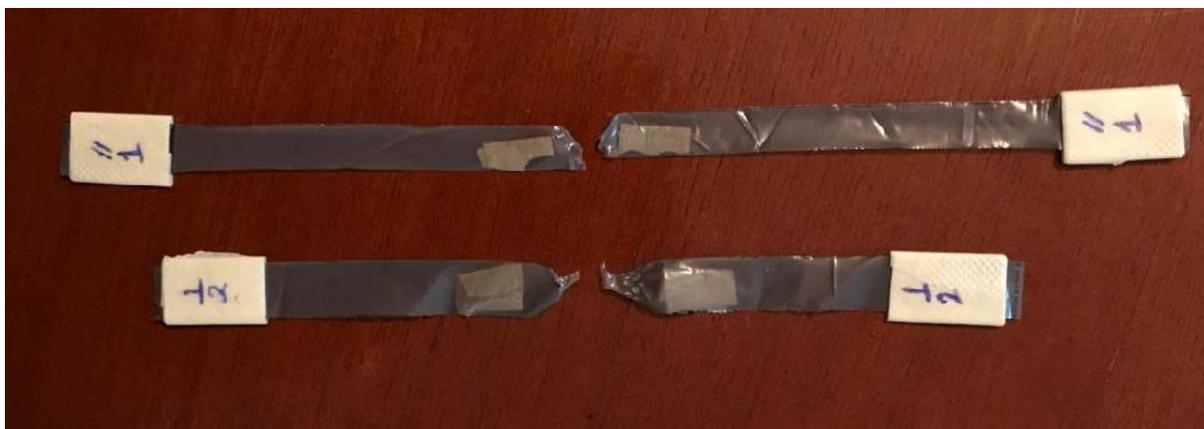
Figura 46. Comparación de las probetas 20R DP y DT luego de la rotura.
