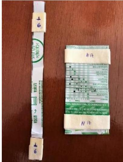
Figura 17. Probetas de sachet de leche de tracción (izquierda) y fractura (derecha) con cinta de papel adicionada en los extremos para evitar el deslizamiento en las mordazas.
