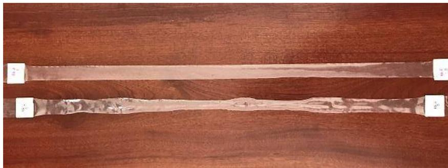
Figura 25. Probetas DP (arriba) y DT (abajo) de la película PE/PA luego de ensayar.
