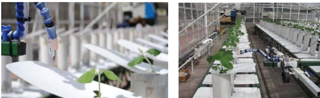
Figure 5.1: Plataforma robot de ensayo para plantas de soja.
