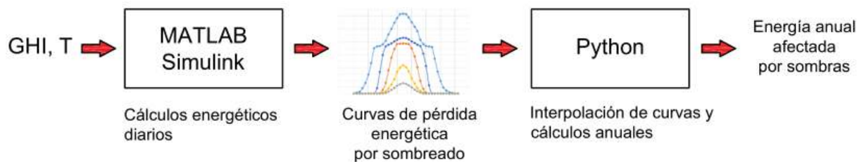
Figura 4.35 Diagrama mostrando el uso en Python de las curvas generadas en Matlab.
