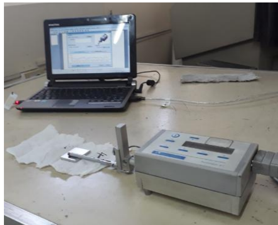
Figura 33. Perfilómetro de contacto Taylor Hobson Surtronic 3+ midiendo la rugosidad de una superficie prismática
