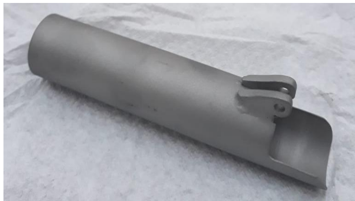
Figura 79. Probeta de geometría compleja sin electropulir
