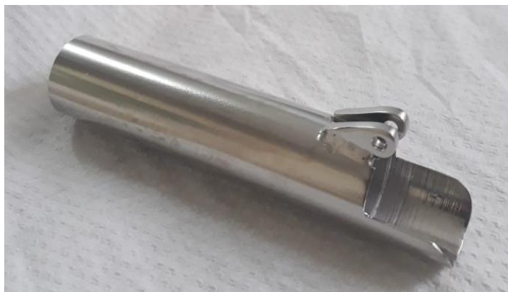
Figura 80. Probeta de geometría compleja electropulida
