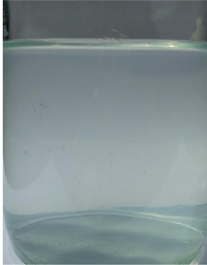
**Figura 3.8.** Disolución de la goma xántica con agua a 60°C y agitación con un homogenizador.
