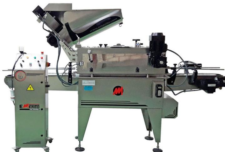
**Figura 8.16.** Cerradora automatica twist-off.
