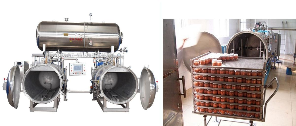
**Figura 8.17.** Autoclave cilíndrico horizontal (izquierda) y carro para envases (derecha).
