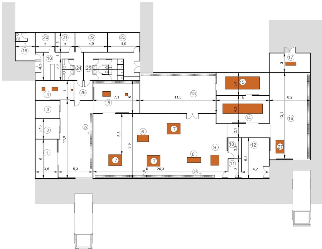
**Figura 9.2.** Layout de la planta elaboradora de sopa de pescado.
