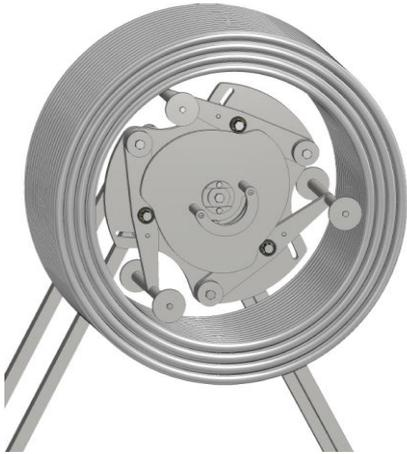
*Figura 2-46. Funcionamiento y modo de operación. Brazos cerrados.*
