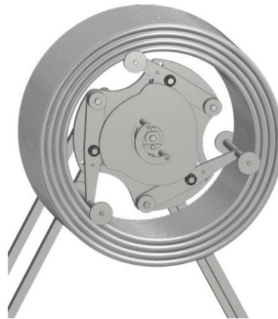
*Figura 2-47. Funcionamiento y modo de operación. Brazos en contacto con la bobina, listos para anclar su posición.*
