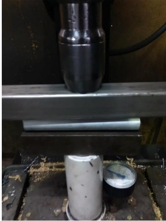
Figura 2-70 Medición de aplastamiento.
