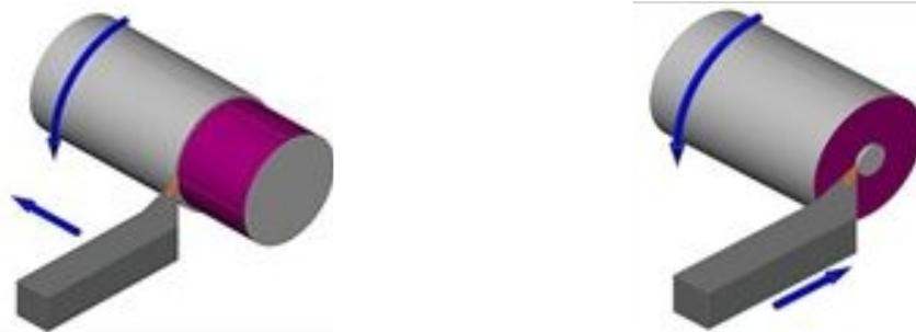
Fig. 5) Esquemas para las operaciones de: a) Cilindrado; b) Refrentado.
