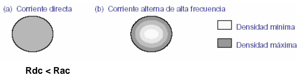
Figura 3.5.1.1. Densidad de corriente en un conductor sometido a corriente continua o directa y a corriente alterna.
