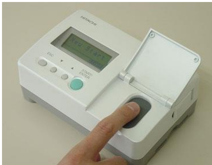
Figura 5. Medidor no invasivo de la empresa Hitachi. Si bien es más voluminoso que otros modelos, tiene funcionalidades que lo hacen apropiado para personas que no sean usuarias nativas de computadoras o teléfonos celulares.
