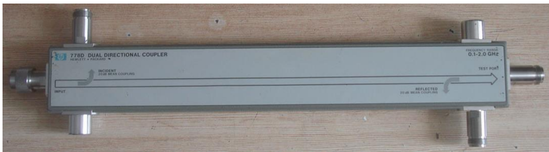
Figura 41. Acoplador direccional HP778D.
