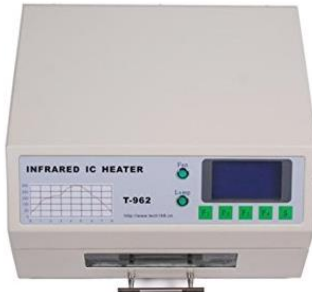
Figura 67. Imagen del horno Infrarrojo T-962.
