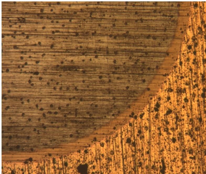
**Figura 75.** Detalle de la impronta sobre muestra Nro. 2.
