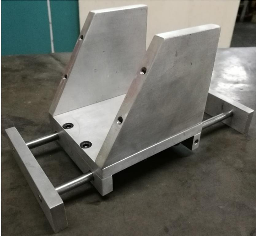
**Figura 62.** Ensamble del carro de portamuestras.
