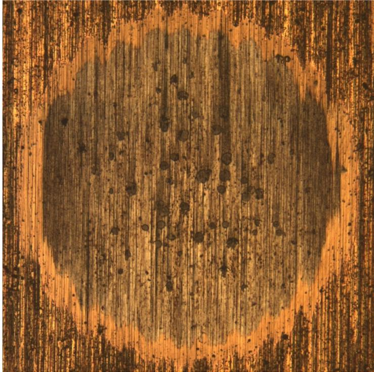
**Figura 76.** Impronta sobre muestra Nro. 3 con esfera de 20 mm de diámetro.
