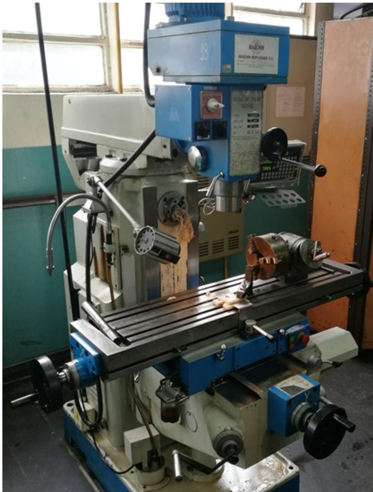
**Figura 58.** Fresadora combinada utilizada para el mecanizado.
