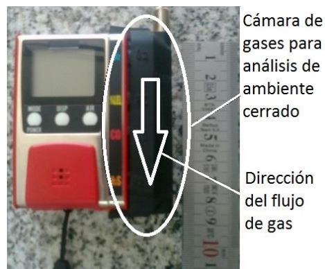
Figura 3.6. Analizador portátil de CO.
