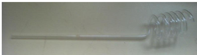
Figura 3.13. Serpentín de vidrio de cuarzo.
