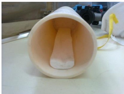
Figura 3.14. Soporte para el serpentín de vidrio de cuarzo.
