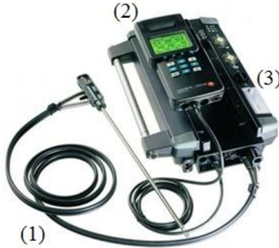
Figura 2.8. Sistema de análisis de productos de combustión: (1) sonda de muestreo; (2) unidad de control; (3) analizador.
