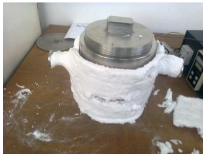
Figura 3.12. Aislación térmica de la cámara (Ensayo II).
