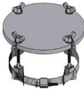
Figura 3.16. Cierre de acero inoxidable austenítico (Fuente: McDanel).
