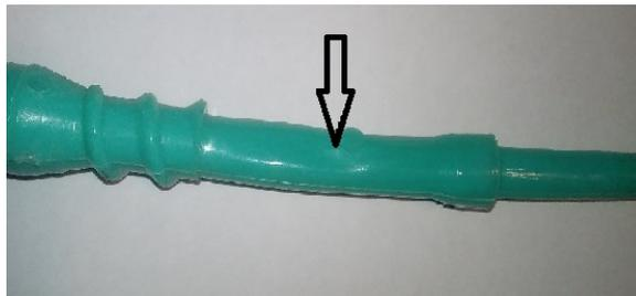
Figura 61: Deformación por falta de tiempo de enfriamiento
