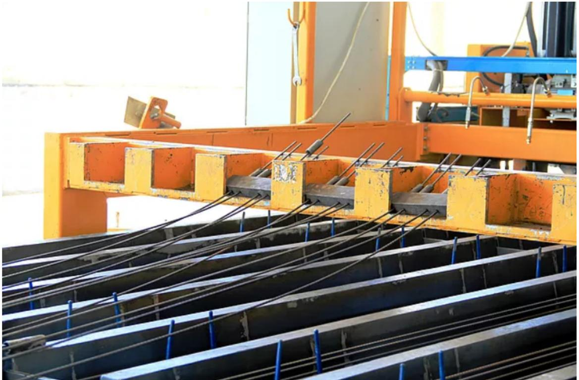
Figura 6: colocación de los Porta Vainas al molde
