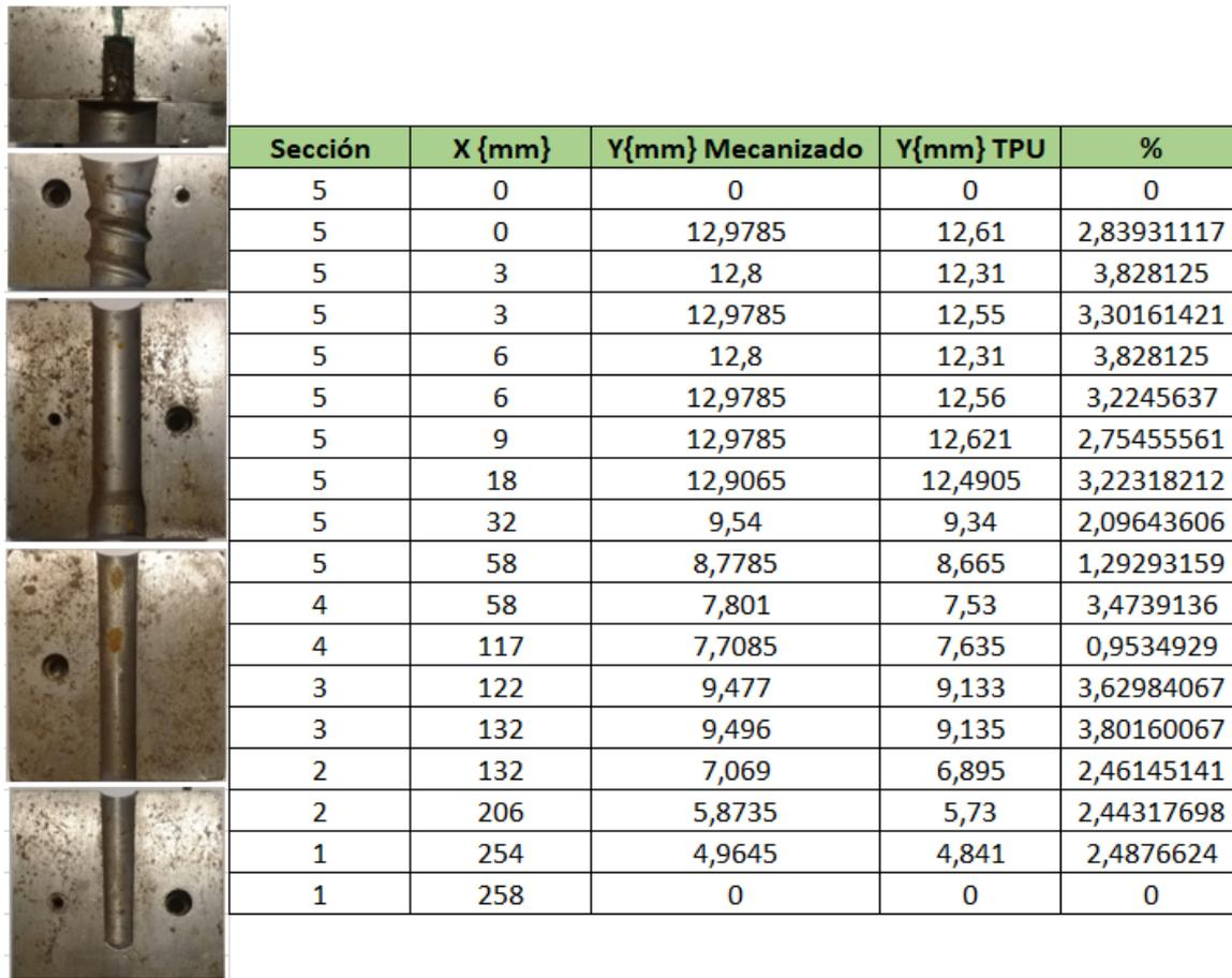
Figura 100: Coordenadas de los perfiles Mecanizado e Inyectado
