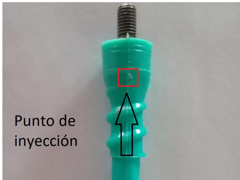
Figura 32: canal de inyección común de las piezas Termo-formadas
