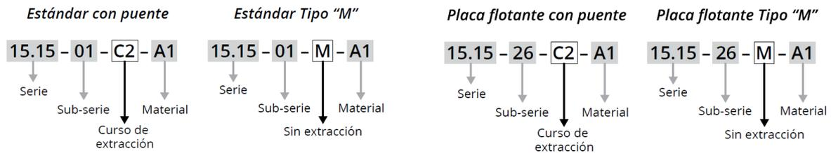
Figura 73: código para Configuración Standar
