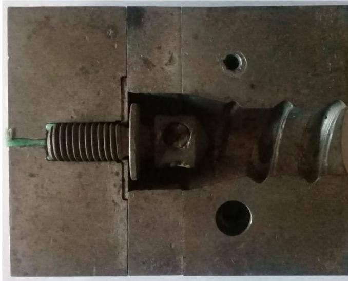
Figura 92: Modelo terminado del sistema de sujeción del inserto con imán
