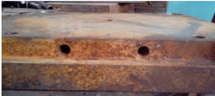
Figura 121: Salida de Agua, Sistema en Serie
