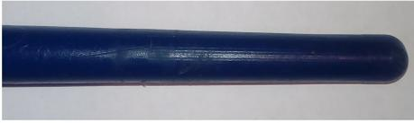
Figura 25: Lineas de Mecanizado
