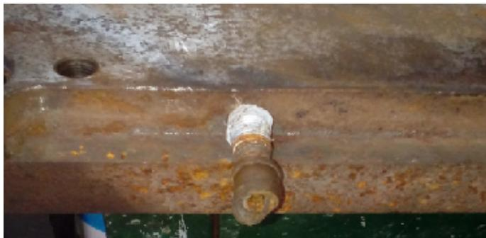
Figura 122: Entrada de Agua, Sistema en Serie
