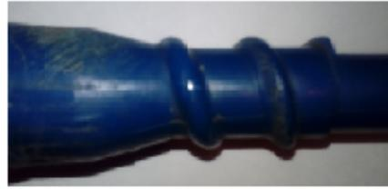
Figura 26: Lineas de Mecanizado
