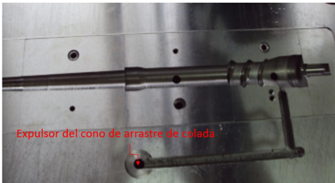
Figura 97: Posición del expulsor del cono de la boquilla
