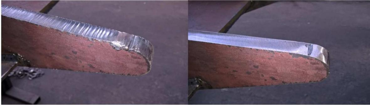
*Figura 30: Antes y después del pulido. Fuente: Solana SRL*
