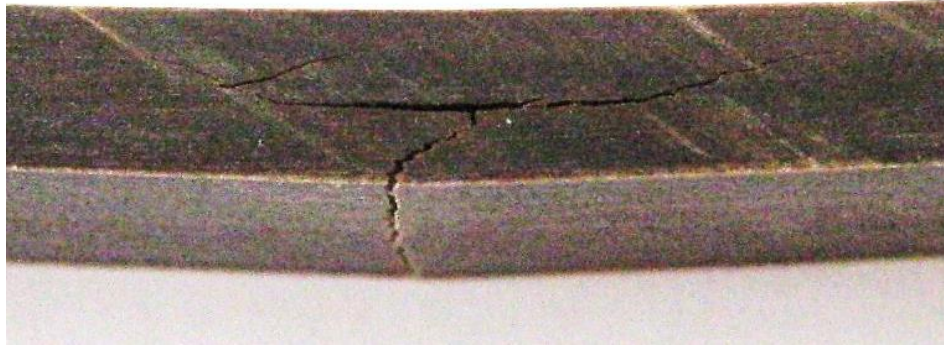
Figura 29. Fotografía de una muestra LK10PF ensayada en flexión.
