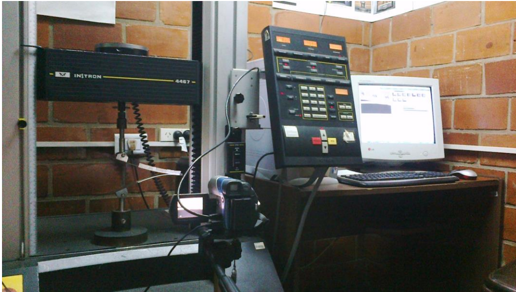
Figura 19. Configuración del ensayo de delaminación.
