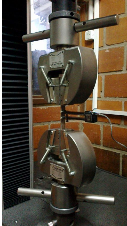
Figura 14. Configuración del ensayo en tracción uniaxial.
