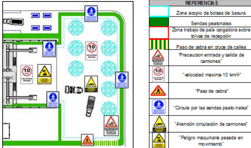
Figura 21. Detalle de la zona de descarga de basura y zona de trabajo de la pala-cargadora. Fuente: Elaboración propia.
