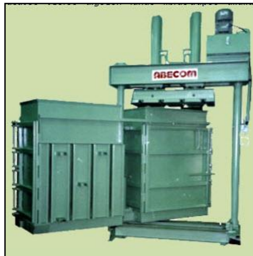
Figura 10. Prensa de PEAD y PET similar a la existente en la planta de la cooperativa CURA LTDA. Fuente: Mercado libre.
