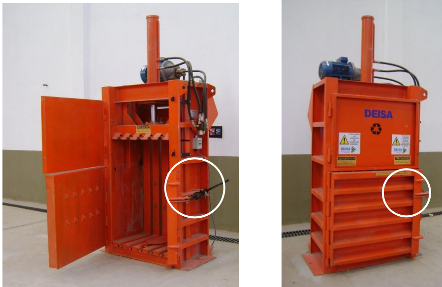
Figura 12. Prensa de cartón y papel similar a la existente en la planta. Se observan los sistemas de seguridad: enclavamiento de puerta abierta y sistema de hombre muerto.
