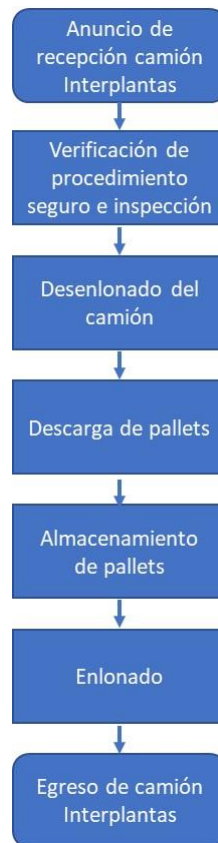
Figura 45: Flujograma recepción y descarga camiones Interplantas Fuente: Elaboración propia en base a datos suministrados por la empresa
