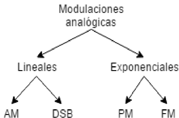
Figura 4-12: Clasificación y ejemplos de modulaciones analógicas.
