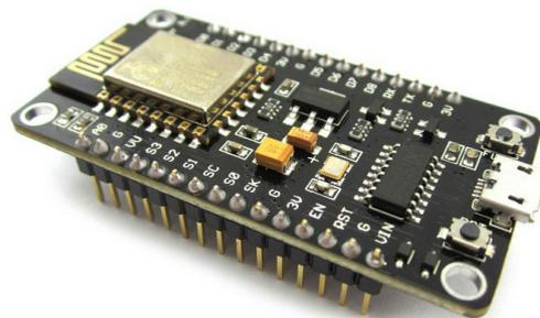
**Figura 2.7** – *Módulo ESP-12E DEV Kit.*
